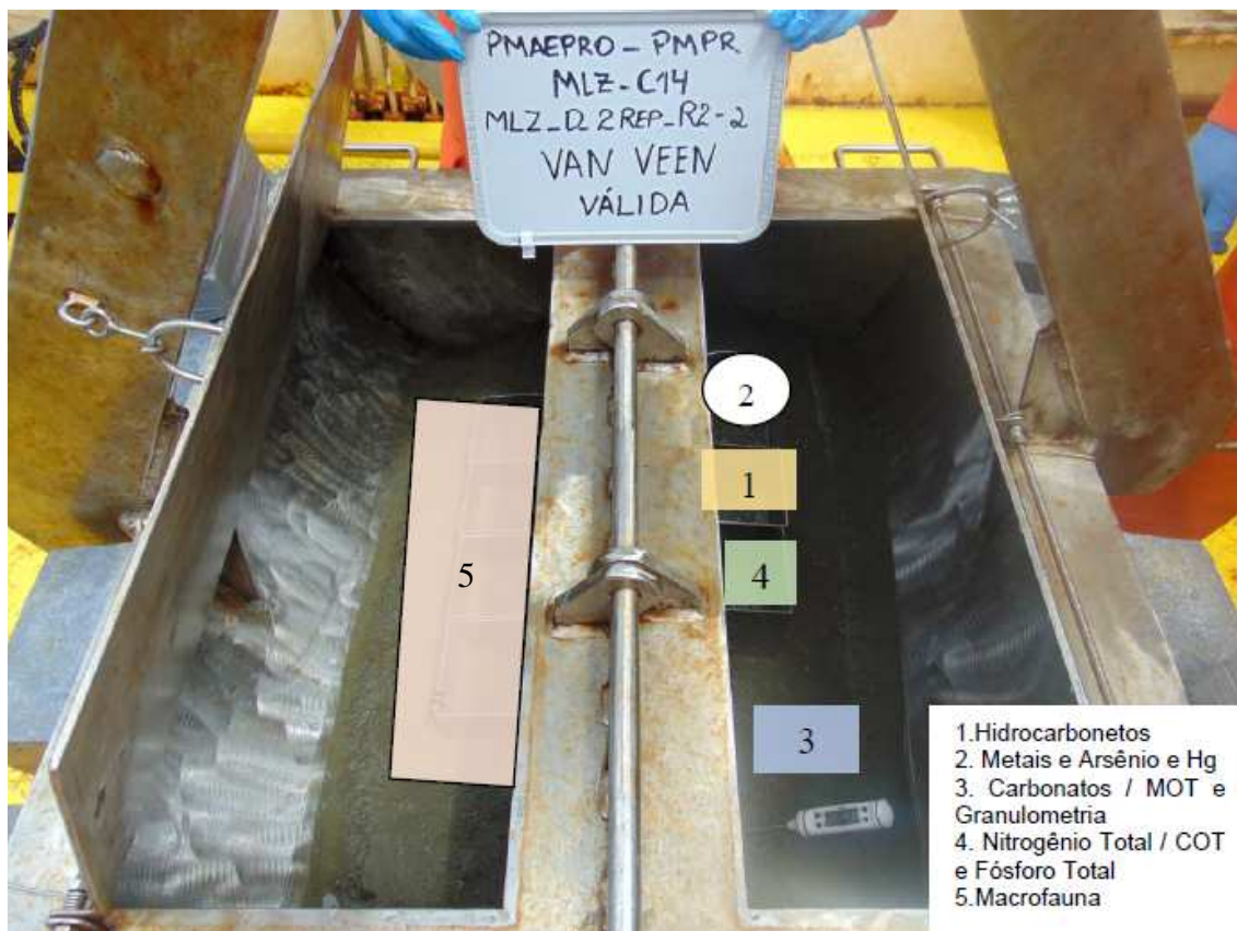
Figura IV-10 – Esquema de distribuição dos corers no Mini Box Corer para sub-amostragem dos parâmetros analisados.
