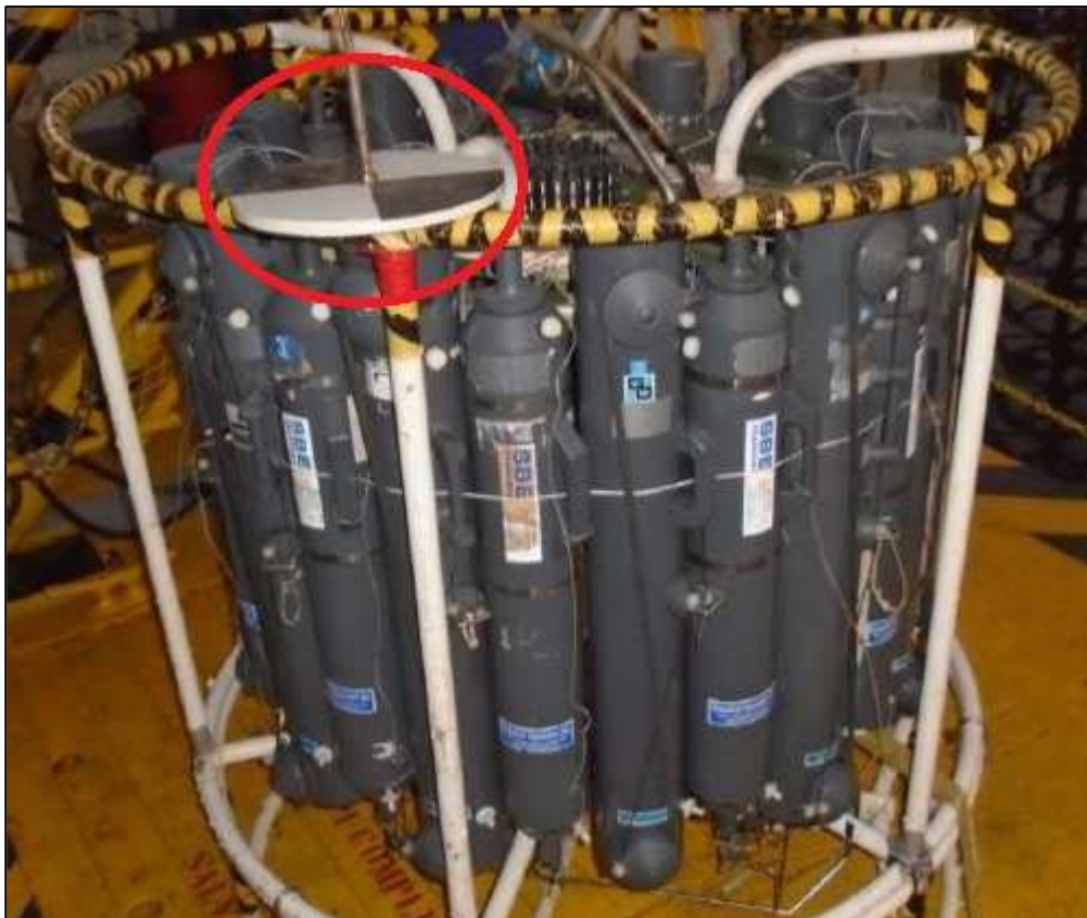
Figura IV-6 – Em vermelho, disco de Secchi utilizado para medir a transparência da coluna da água durante a PMAEpro-BS_PMPR_MLZ_C14.
