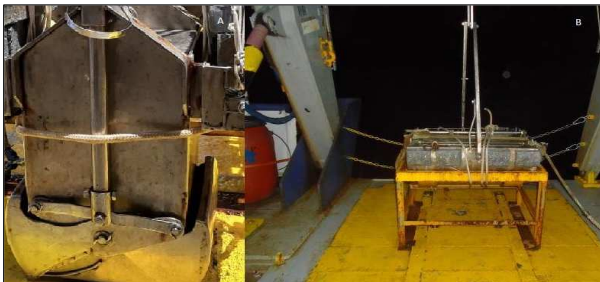
Figura IV-9 – A) Mini Box Corer (30 x 30 x 50 cm) e B) Van Veen, utilizados para a coleta de amostras de sedimento e bentos, durante a PMAEpro-BS_PMPR_MLZ_C14.
