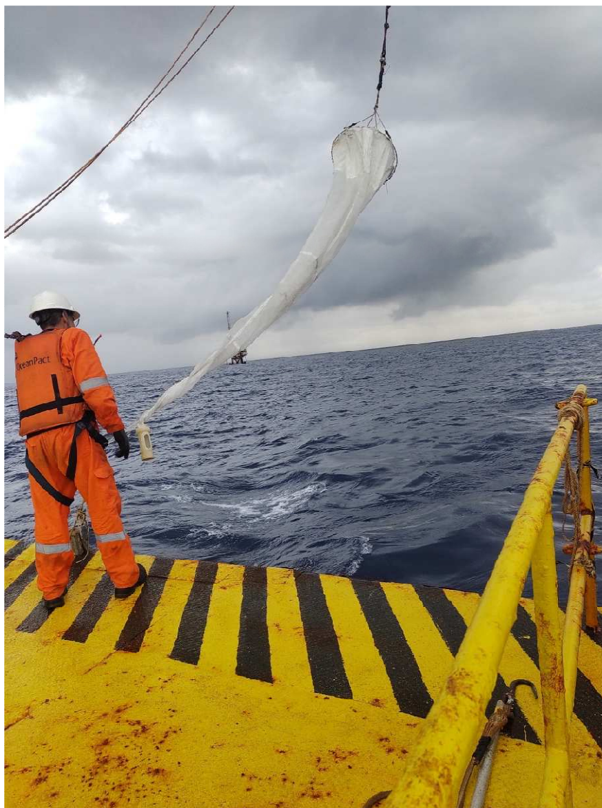
Figura IV-7 – Rede cilindro-cônica com malha de 200 \mu m para coleta de amostras de zooplâncton utilizada durante a PMAEpro_PMPR_MLZ_C14.
