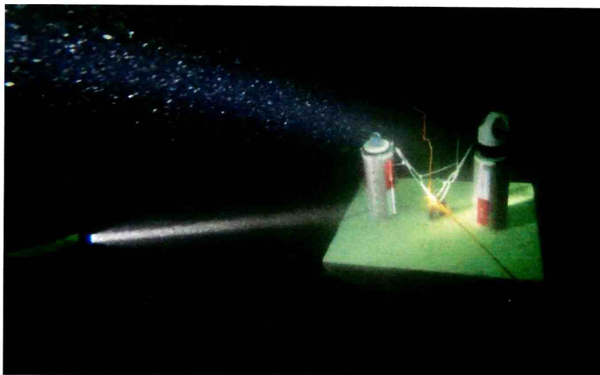
Figura D.1-1: OceanPod (à esquerda) e ADCP (à direita) instalados na poita de um observatório submarino.
