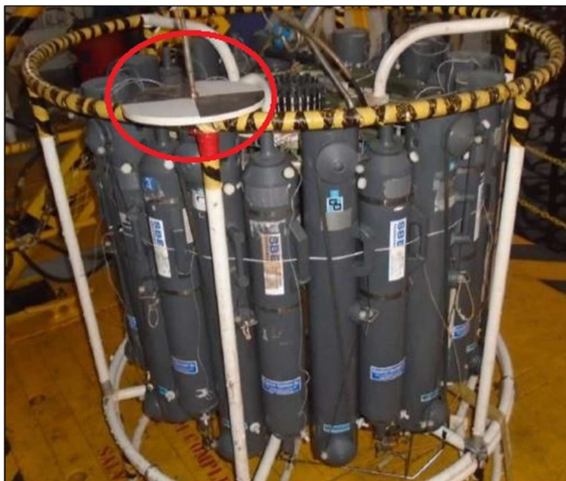
Figura IV-5 – Disco de Secchi utilizado para medir a transparência da coluna da água durante o PMPR_URG_C15.
