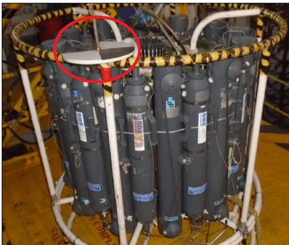
Figura IV-5 – Disco de Secchi utilizado para medir a transparência da coluna da água durante a PMPR_PIL-LL_C14.
