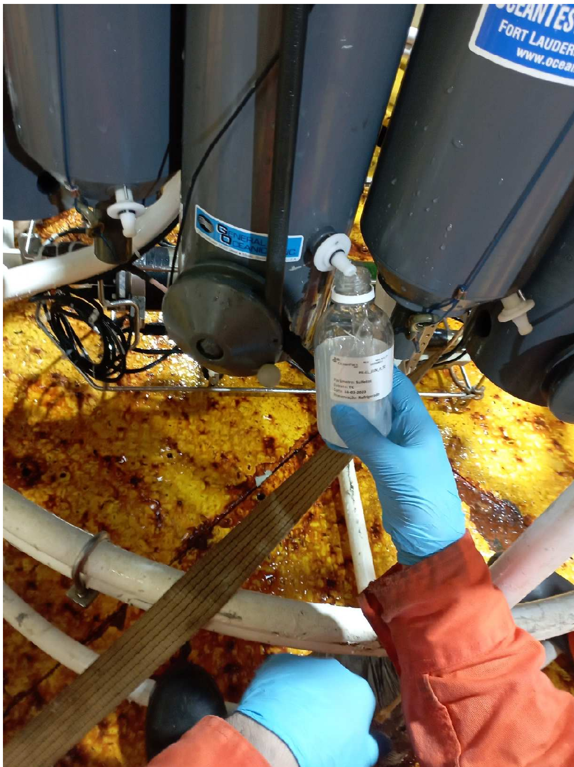
Figura IV-4 – Rosette com garrafas de coleta de amostras de água do modelo Go-flo utilizadas na atual campanha de monitoramento.
