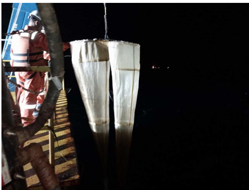
Figura IV-7 – Rede bongô com malhas de 300 e 500 \mu\text{m} utilizada durante a PMPR_PIL-LL_C14 para coleta de amostras de ictioplâncton.
