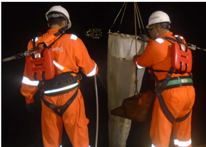
Figura IV-6 – Rede cilindro-cônica com malha de 200 \mu\text{m} para coleta de amostras de zooplâncton utilizada durante a PMPR_PIL-LL_C14.
