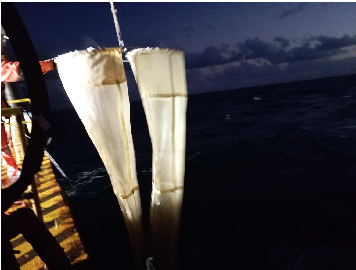
Figura IV-7 – Redes bongô com malhas de 300 e 500 \mu\text{m} para coleta de amostras de ictioplâncton utilizadas durante a PMPR_PIL-SAP_C10.
