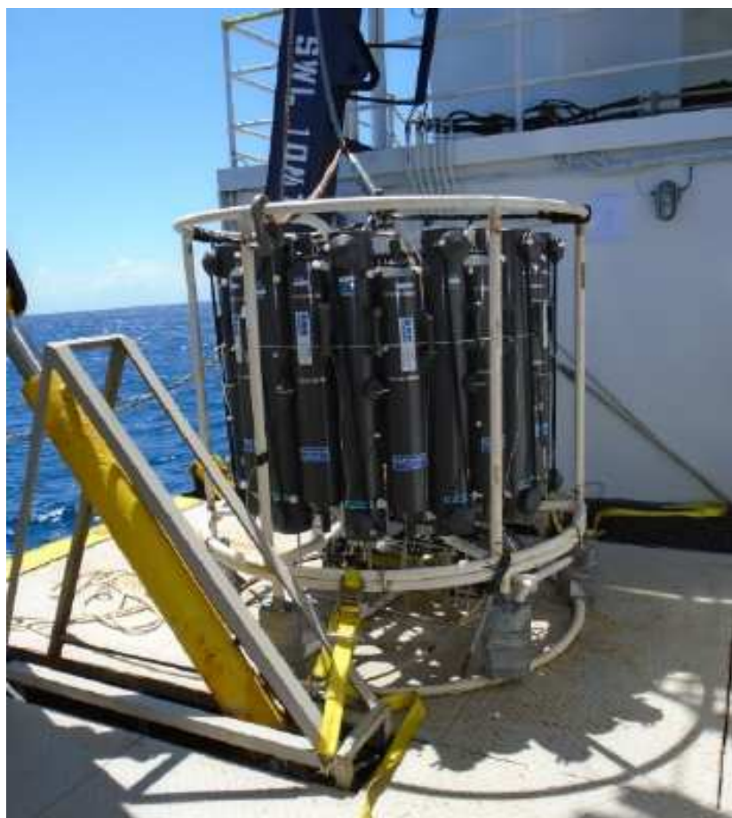
Figura IV-4 – Rosette com garrafas de coleta de amostras de água dos modelos Niskin e Go-flo utilizadas na atual campanha de monitoramento.
