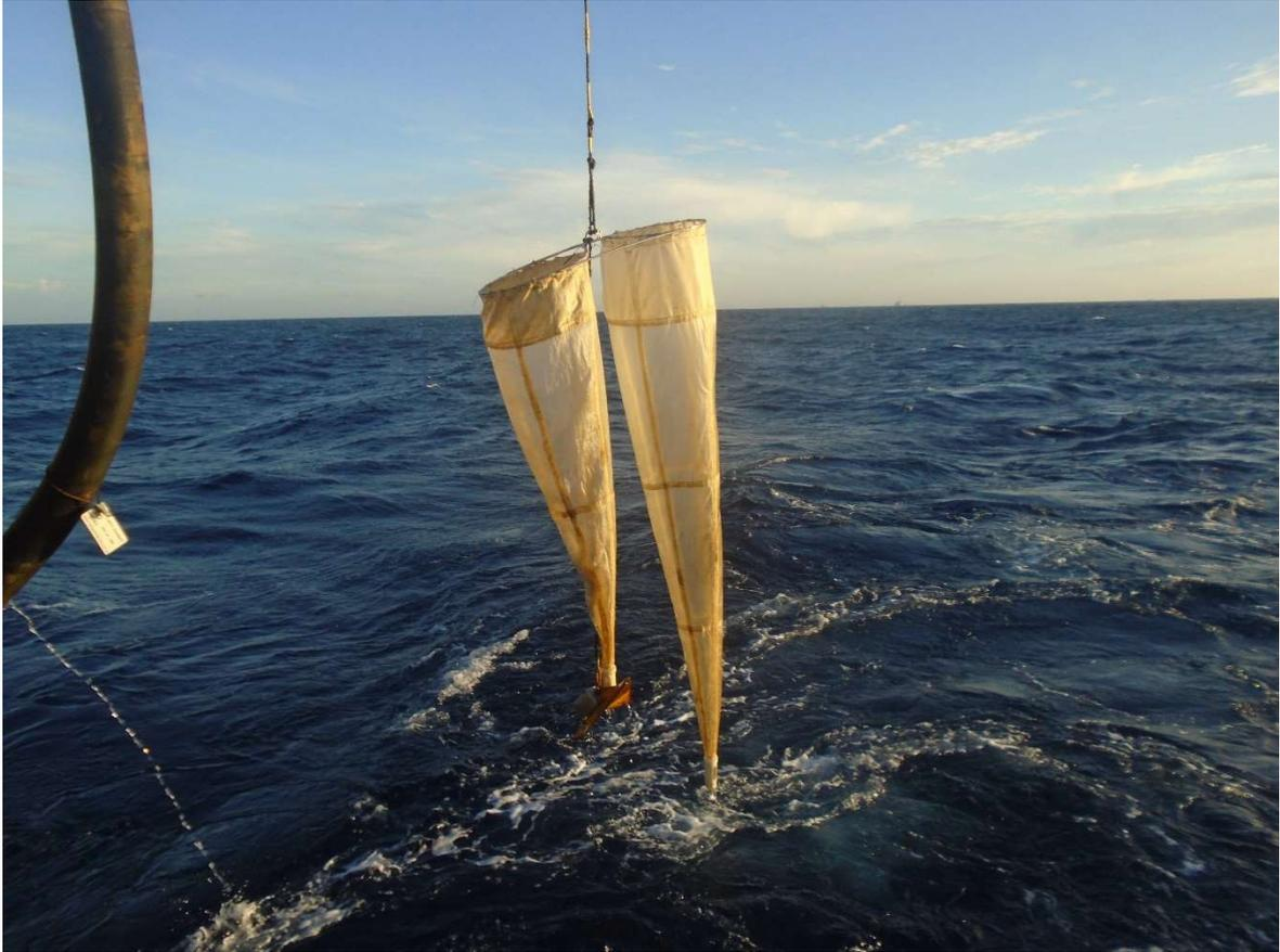
**Figura IV-7** – Rede bongô com malhas de 300 e 500  $\mu\text{m}$  para coleta de amostras de ictioplâncton, utilizada durante a PMPR\_PIL-LL-NE\_C10.
