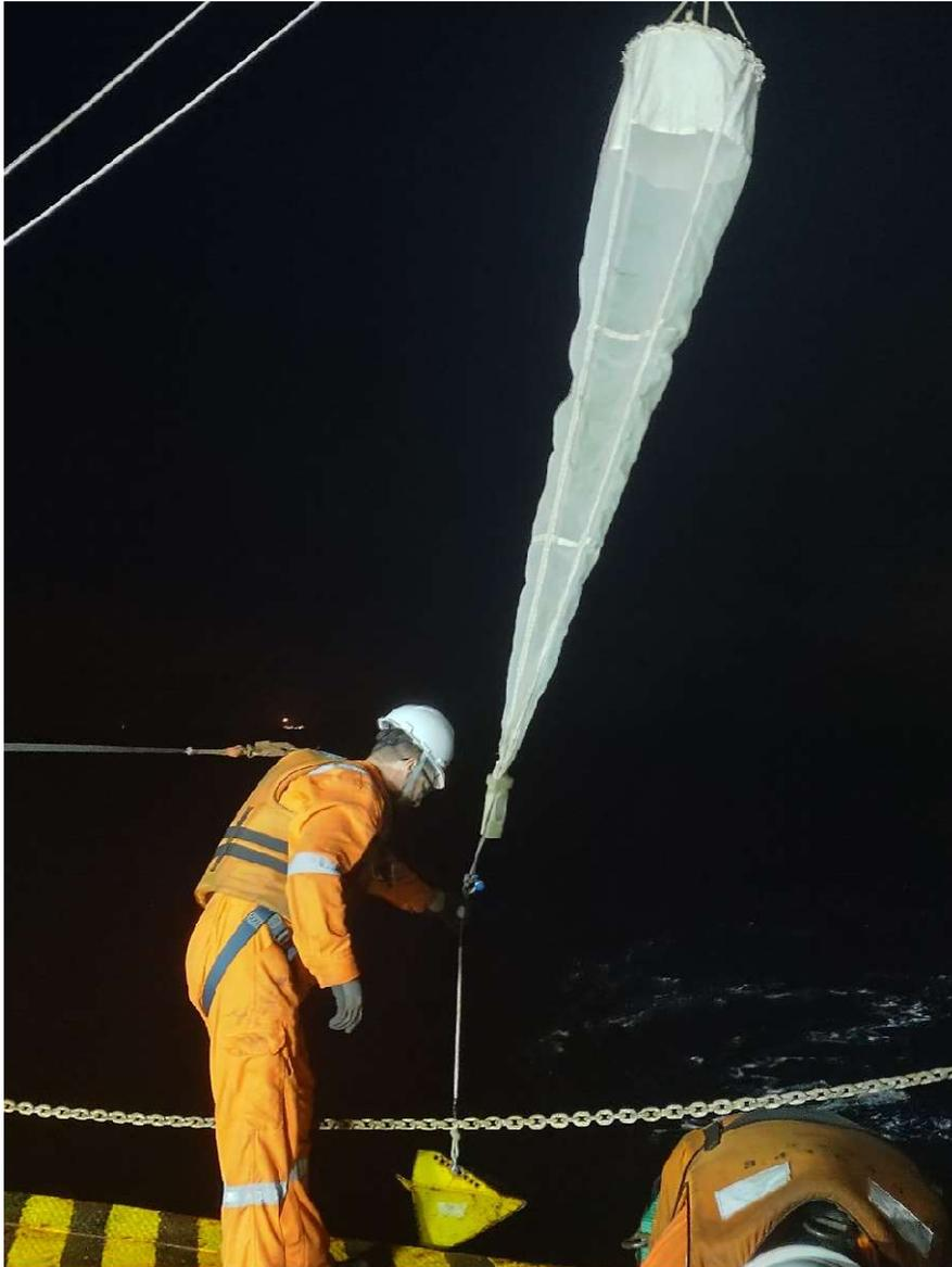
**Figura IV-6** – Rede cilindro-cônica com malha de 200  $\mu$ m para coleta de amostras de zooplâncton utilizada durante a PMPR\_PIL-LL-NE\_C10.
