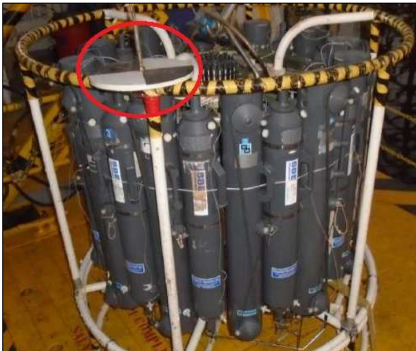
Figura IV-5 – Disco de Secchi utilizado para medir a transparência da coluna da água durante a DP-IRA-S_C9.
