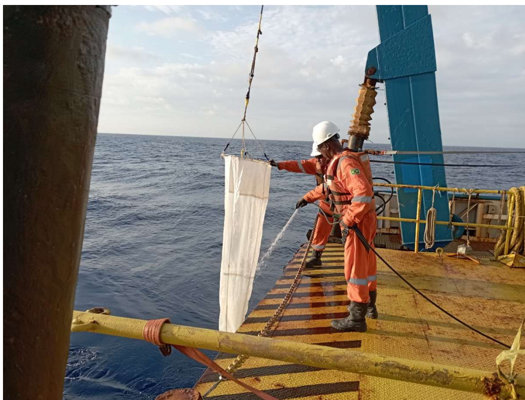
Figura IV-6– Rede cilindro-cônica com malha de 200 \mu m para coleta de amostras de zooplâncton utilizada durante a DP-IRA-S_C9.
