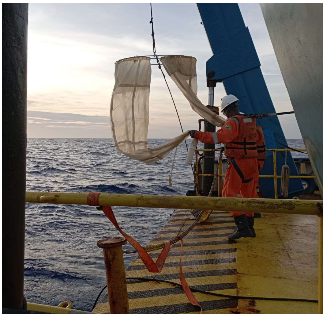
Figura IV-7 – Rede bongô com malhas de 300 e 500 \mu\text{m} para coleta de amostras de ictioplâncton, utilizada durante a DP-IRA-S_C9.
