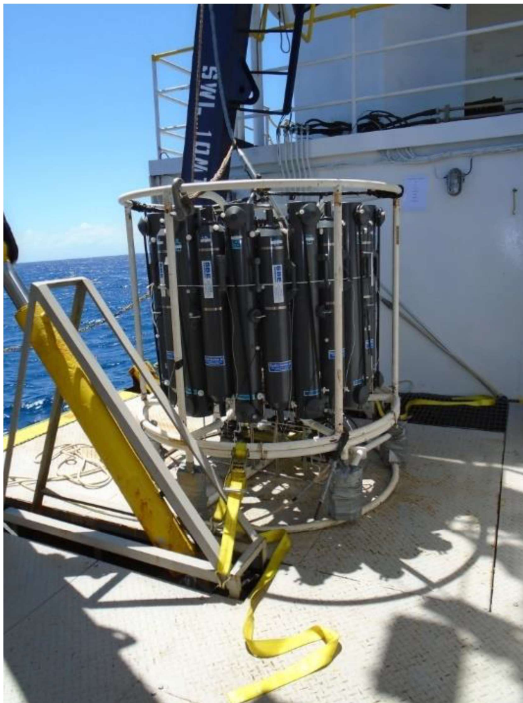
Figura IV-4 – CTD/Rosette com garrafas de coleta de amostra de água dos modelos Niskin e Go-flo utilizadas na DP-IRA-S_C9.
