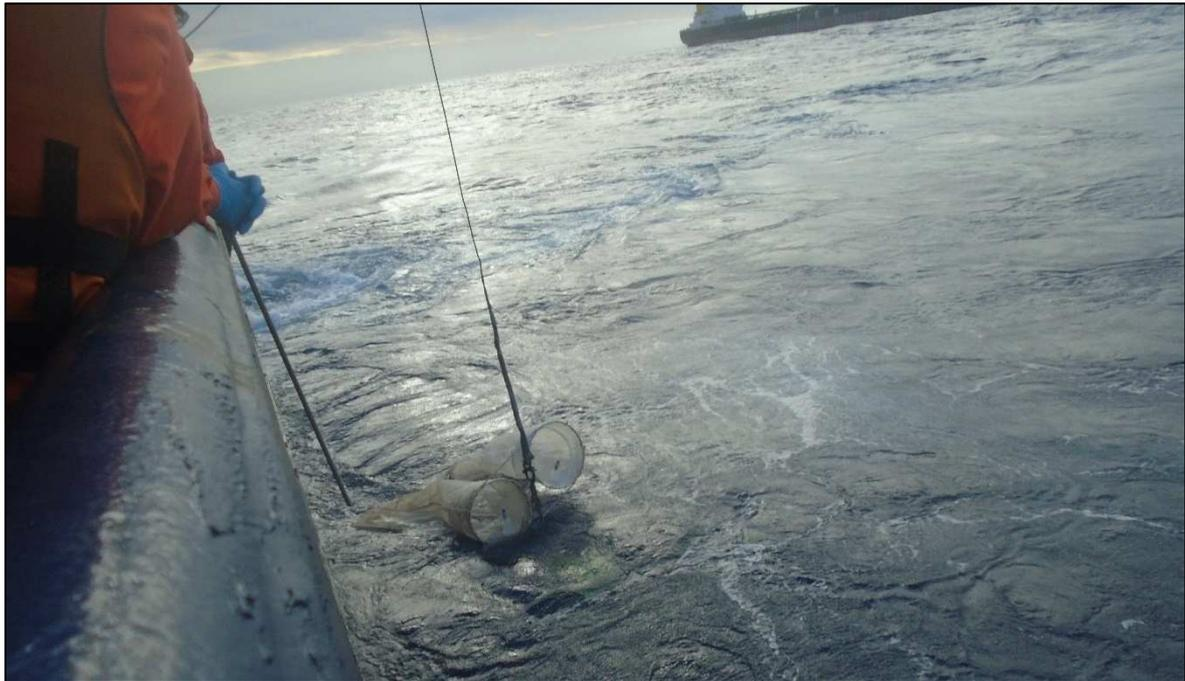
**Figura IV-7** – Rede bongô com malhas de 300 e 500  $\mu\text{m}$  para coleta de amostras de ictioplâncton, utilizada durante a PMPR\_DP-BUZ-1\_C5.
