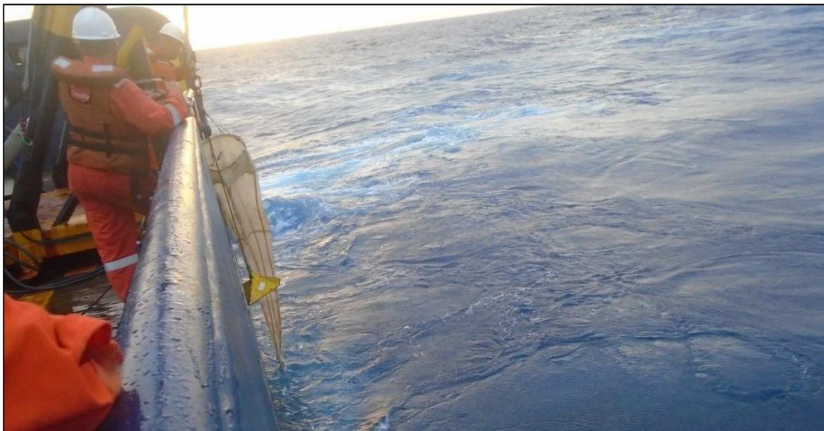
**Figura IV-6** – Rede cilindro-cônica com malha de 200  $\mu\text{m}$  para coleta de amostras de zooplâncton utilizada durante a PMPR\_DP-BUZ-1\_C5.
