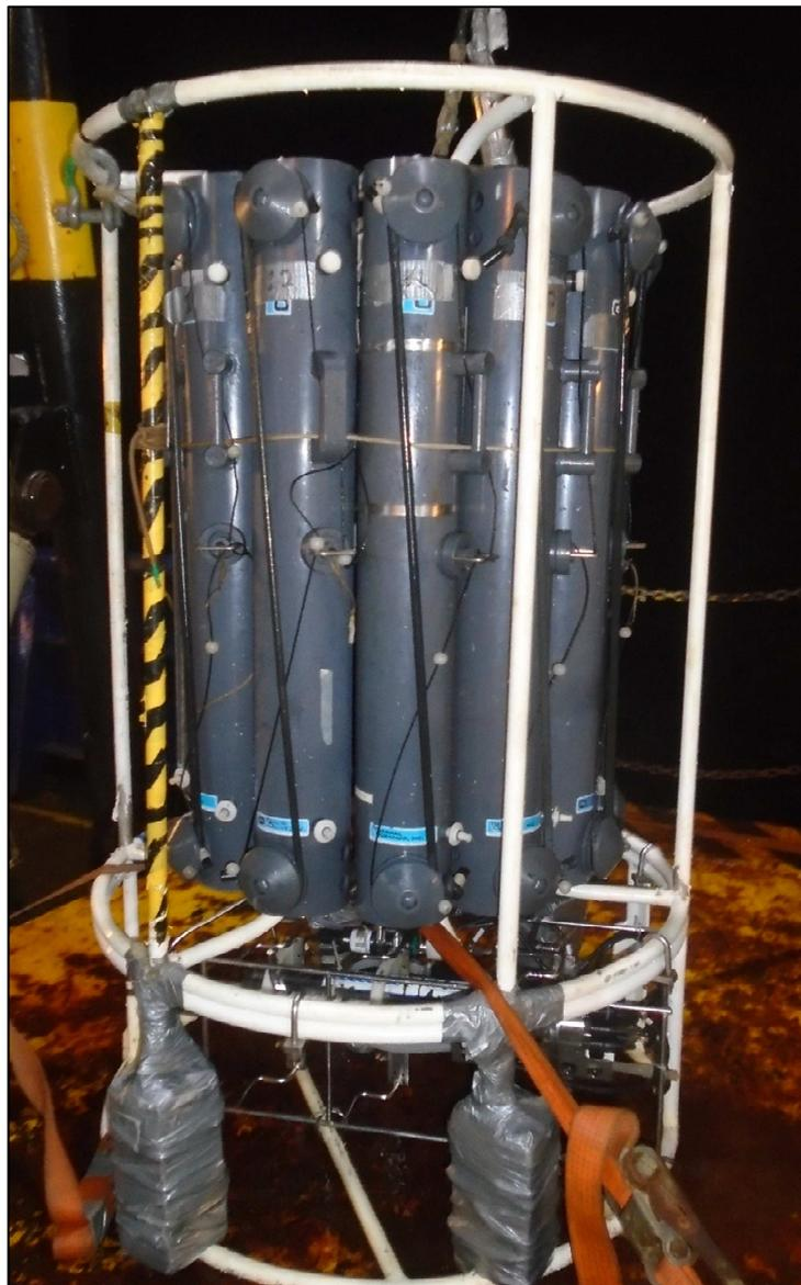
**Figura IV-4** – Rosette com garrafas de coleta de amostras de água dos modelos Niskin e Go-flo utilizadas na atual campanha de monitoramento.
