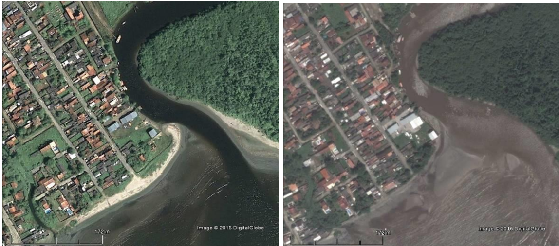
Figura VI.3.5-13 – Erosão da margem direita do Rio Juqueriquerê – imagem da esquerda em 03.04.2009 e da direita em 17.02.2016.
