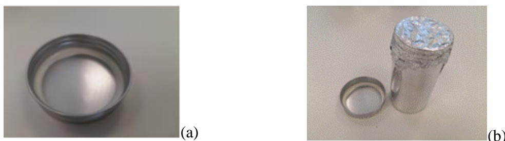
Figura IV.1 – Frascos de alumínio para acondicionamento de amostras para análise de HPAs: (a) visão da tampa mostrando o anel de vedação; (b) modo de utilização de papel de alumínio para evitar contato da amostra com a tampa.
