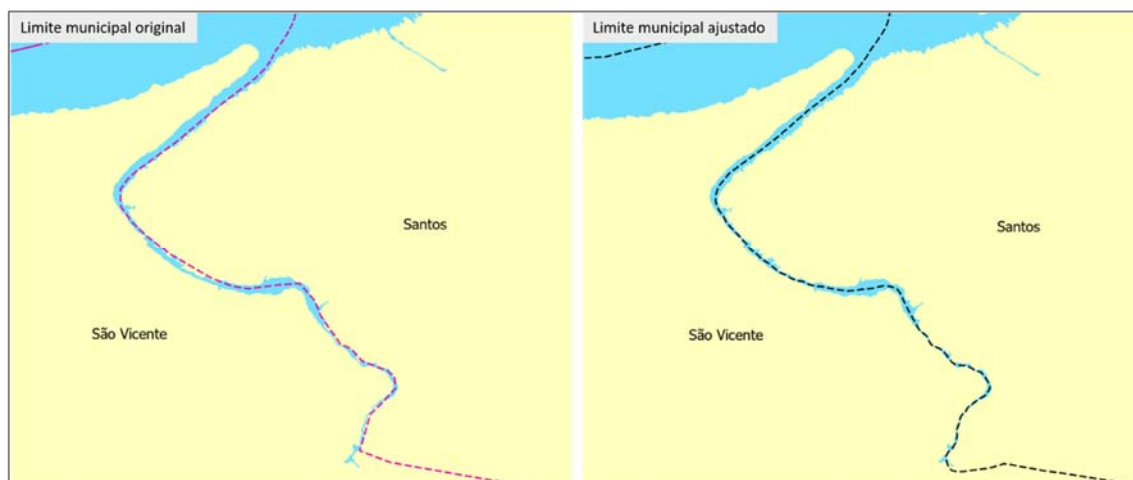
Figura 3.16 - Exemplo de ajuste do limite municipal de acordo com a hidrografia.
