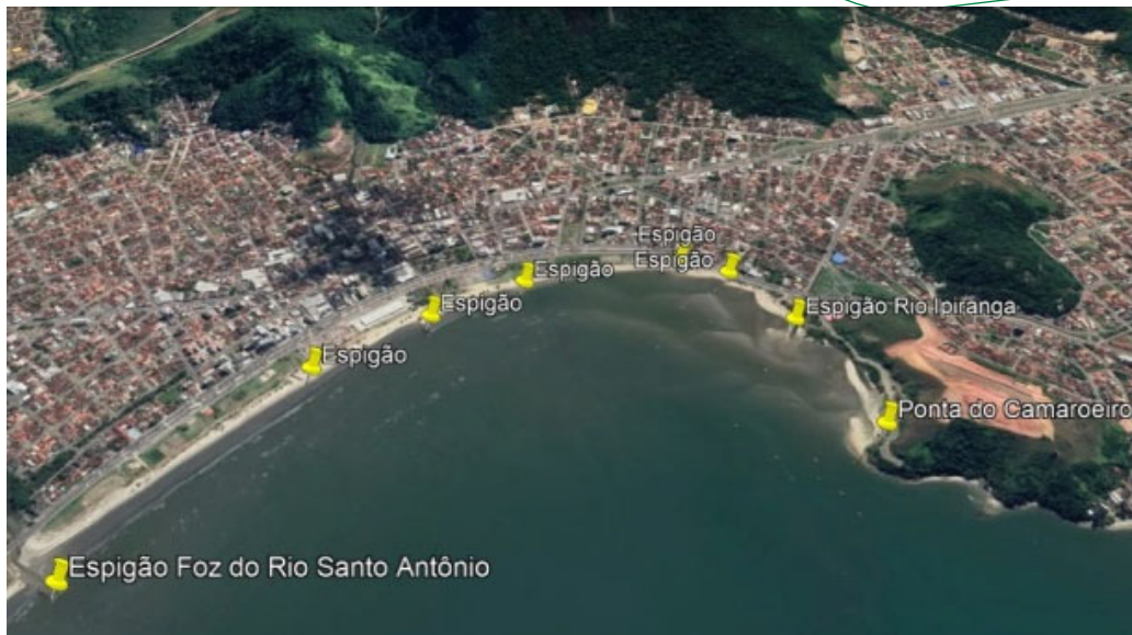
Figura III-15 – Imagem de satélite do setor central e norte da praia de Caraguatatuba. Evidências de deriva litorânea com direção dominante sudoeste (de direita para esquerda) pela acumulação de sedimentos ao norte dos espigões (Fonte: Google Earth).
