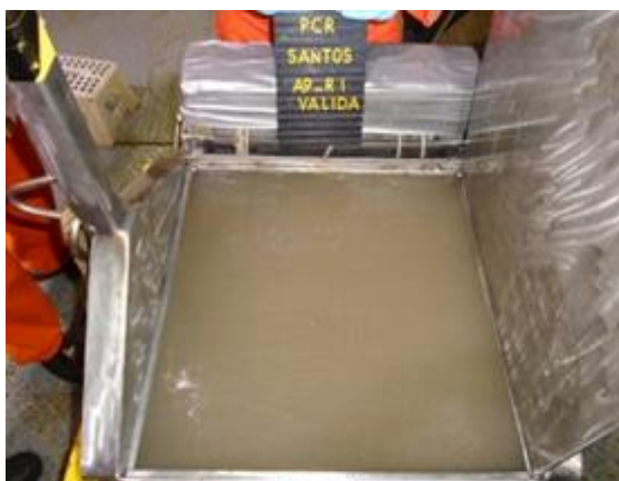
Figura II.4-2: Exemplos de registros fotográficos do sedimento coletados através dos amostradores de fundo: I) e II) sedimento coletado pelo van Veen e III) e IV) sedimento coletado pelo box corer. As fotografias do lado esquerdo (I e III) são as amostras antes da inserção dos gabaritos, e as fotografias do lado direito (II e IV) são pós inserção de gabaritos.
