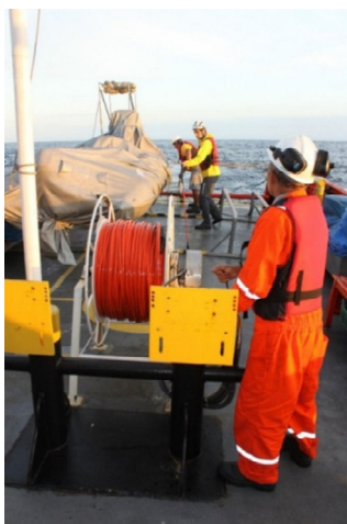
Figura 2: Cabo do MAP sendo lançado na água (esquerda) e detalhe mostrando as cordas com os mosquetões presos no chinese finger (direita). Note que o cabo passa pelo rolete na popa da embarcação antes de ser lançado no mar.
