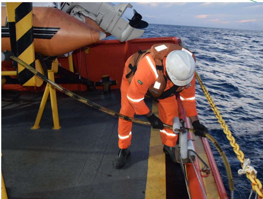
Figura III-5: Exemplo de arranjo de hidrofones lançado a partir da popa da embarcação.
