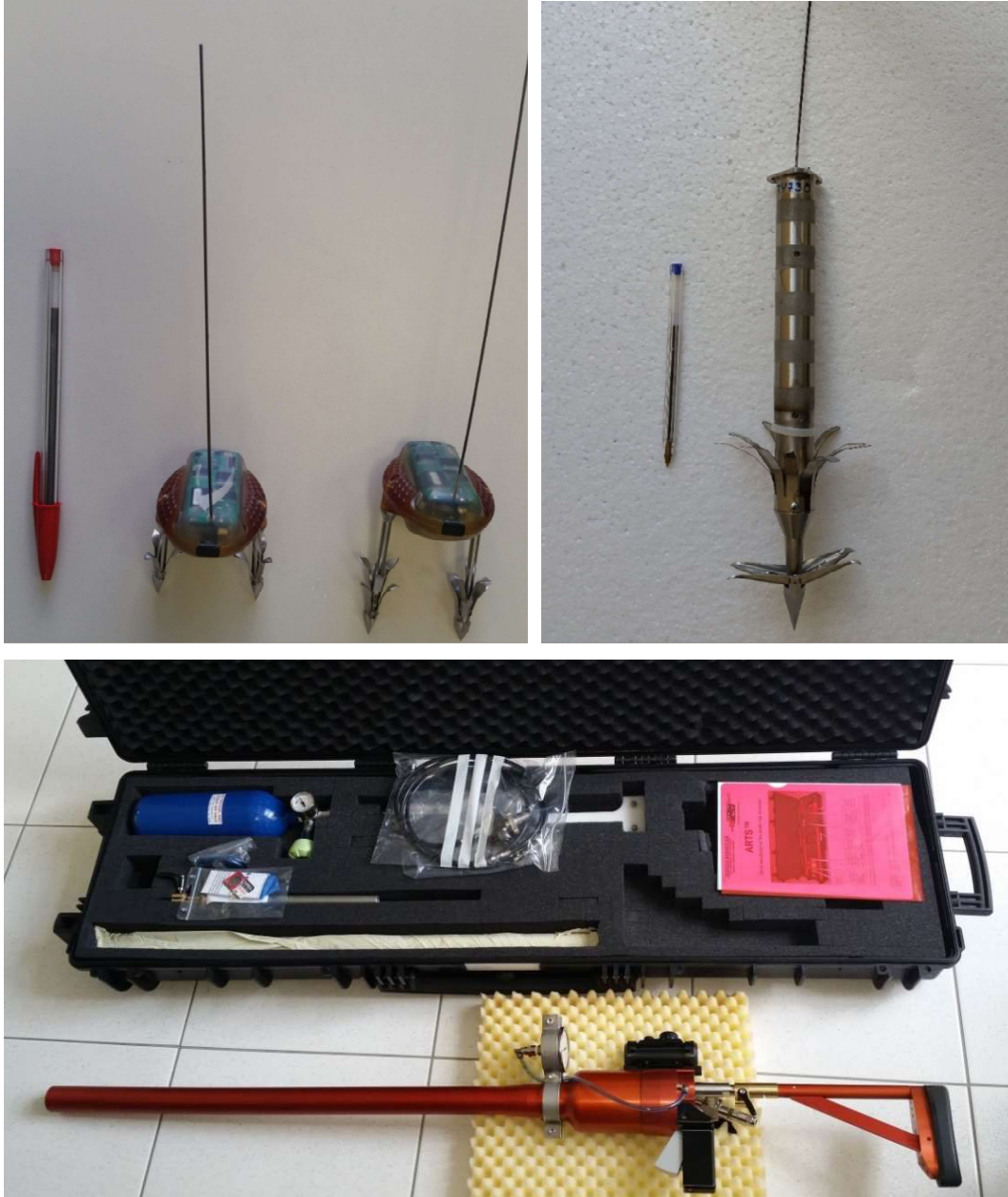
Figura III-8: Configuração LIMPET (acima e à esquerda) e implantável (acima e à direita) para os transmissores SPLASH e rifle de ar comprimido usado para colocação de transmissores satelitais.
