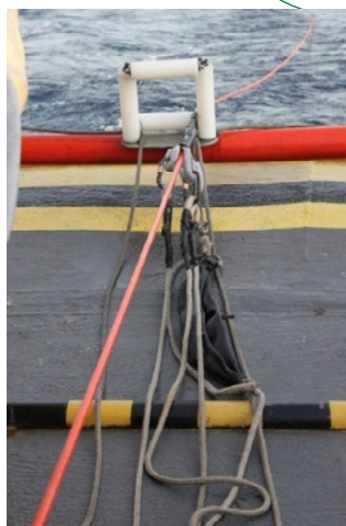
Figura 2: Cabo do MAP sendo lançado na água (esquerda) e detalhe mostrando as cordas com os mosquetões presos no chinese finger (direita). Note que o cabo passa pelo rolete na popa da embarcação antes de ser lançado no mar.
