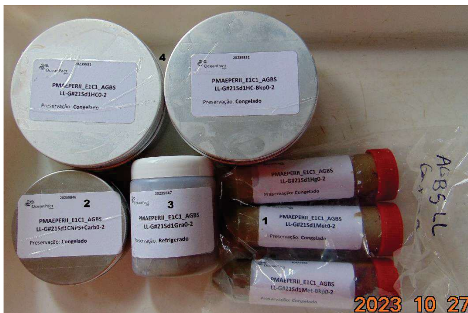
Figura III.1.4.1-5: Frascaria utilizada para acondicionamento das amostras de sedimento do PMAEper Fase II - Etapa I, na AGBS. 1 – Tubos Falcon: Metais e Semimetais; 2 – Frasco de alumínio: COT/NT/Carbonatos; 3 – Frasco de polietileno: Granulometria; 4 – Frasco de alumínio: Hidrocarbonetos.
