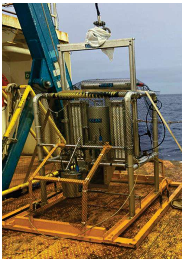
Figura III.1.4.2-1: Equipamento SPI ( Sediment Profile Imaging ) utilizado na aquisição das imagens de PV e SPI, durante a amostragem do PMAEper Fase II – Etapa I, na AGBS.
