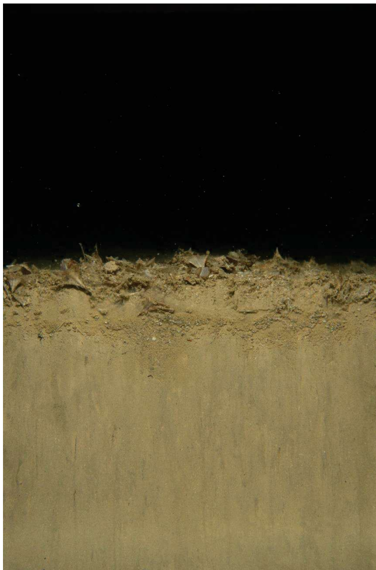
Figura III.1.4.2.2-1: Imagem resultante do SPI mostrando a interface água/sedimento, obtida durante a amostragem da estação G#28_SPI1B (área de Lula) do PMAEper Fase II - Etapa I, na AGBS.
