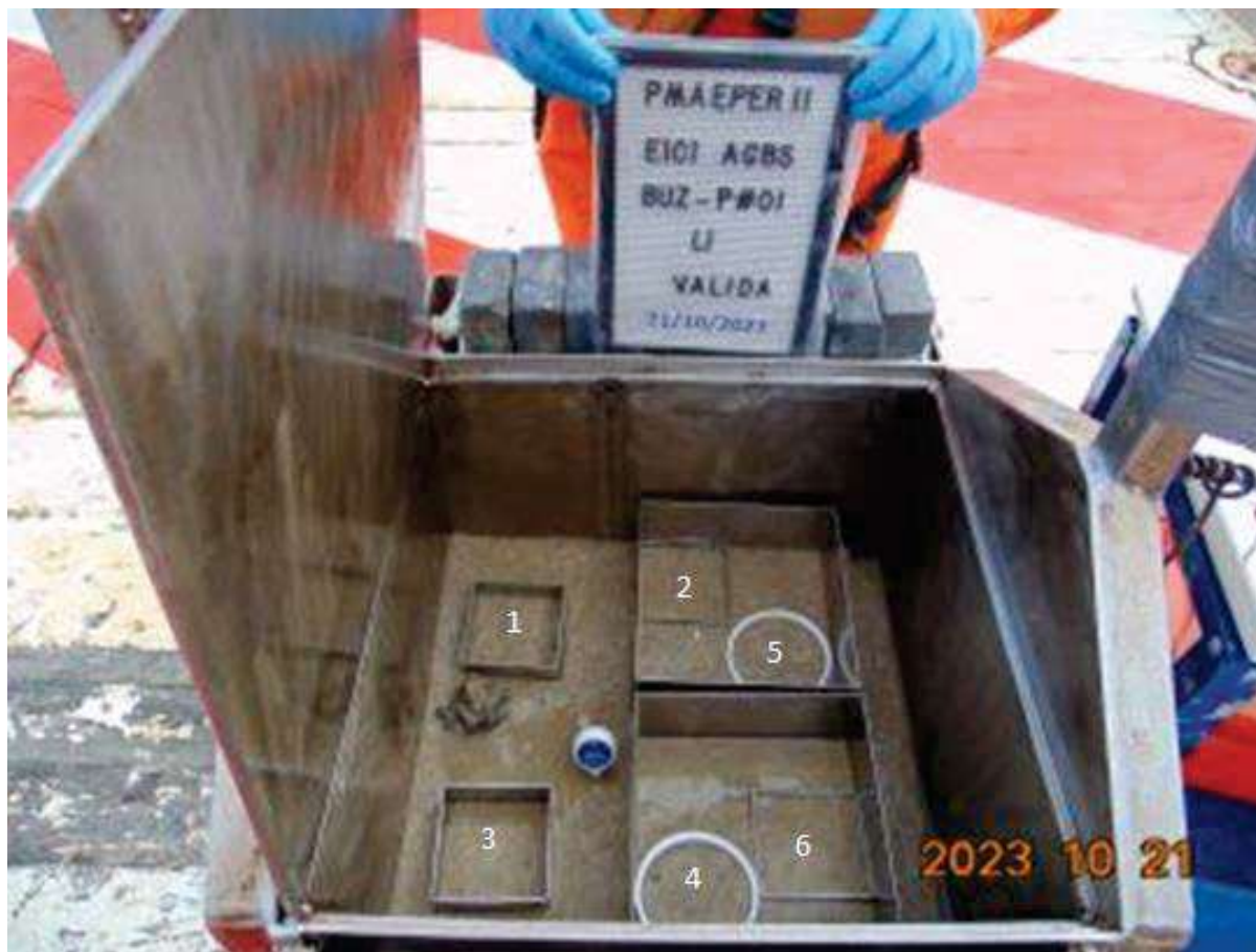
Figura III.1.4.1-4: Esquema de distribuição dos gabaritos para subamostragem dos parâmetros obtidos no PMAEPER Fase II - Etapa I da AGBS. Legenda: 1 - Testemunho extrudido, 2 - COT/NT/Carbonatos, 3 - Granulometria, 4 – Metais e Semimetais (Backup), 5 – Metais e Semimetais e Mercúrio e 6 – Hidrocarbonetos.
