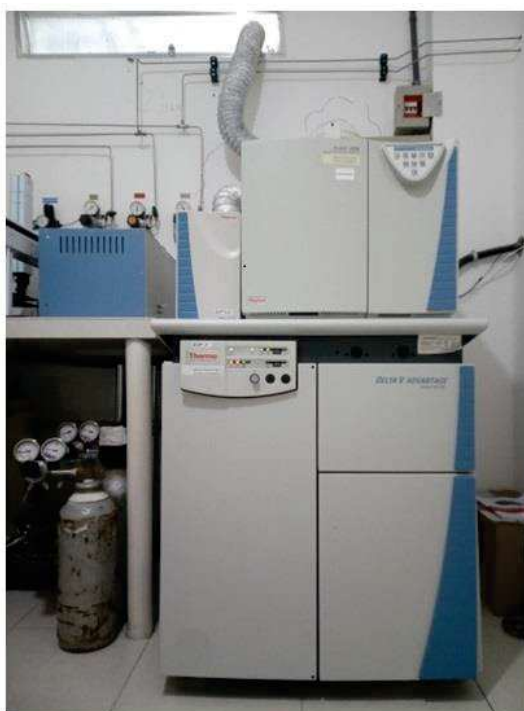
Figura IV.2.2.1-1: Analisador Elementar de Carbono e Nitrogênio, Flash 2000 HT/Delta Advantage ThermoFischer® (parte superior Flash 2000, parte inferior Delta Advantage). Equipamento na Unidade Multiusuário de Análises Ambientais (UMAA/UFRJ).
