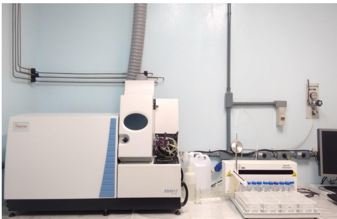
Figura 7.2-4. Espectrômetro de massas com plasma acoplado indutivamente utilizado para as determinações de As, Cd, Cr, Cu, Pb, Mn, Mo, Zn, Ni, Ba e V.
