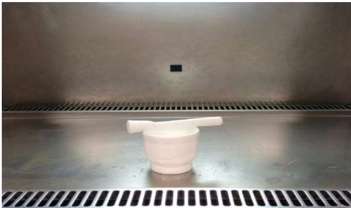
Figura II.1.2-1 - Grau e Pistilo de plástico utilizados na maceração das amostras.
