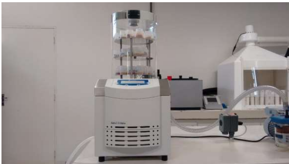
Figura II.2.1.1-1 - Liofilizador utilizado para secagem das amostras.
