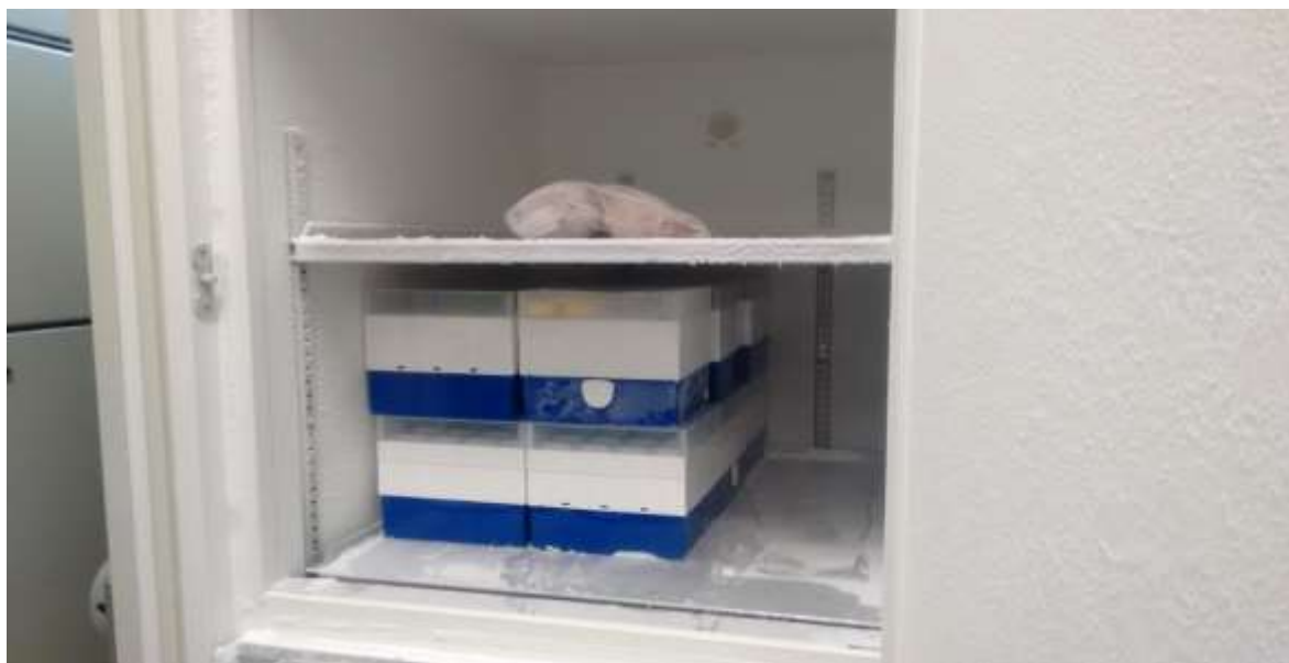
Figura II.1.2-2 - Ultrafreezer (-80°C) utilizado para armazenamento das amostras.
