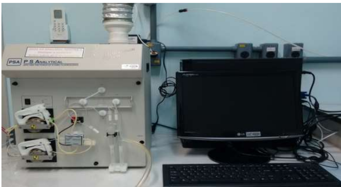
Figura II.2.2.3-1 - Espectrômetro de fluorescência atômica utilizado para a determinação de Hg.
