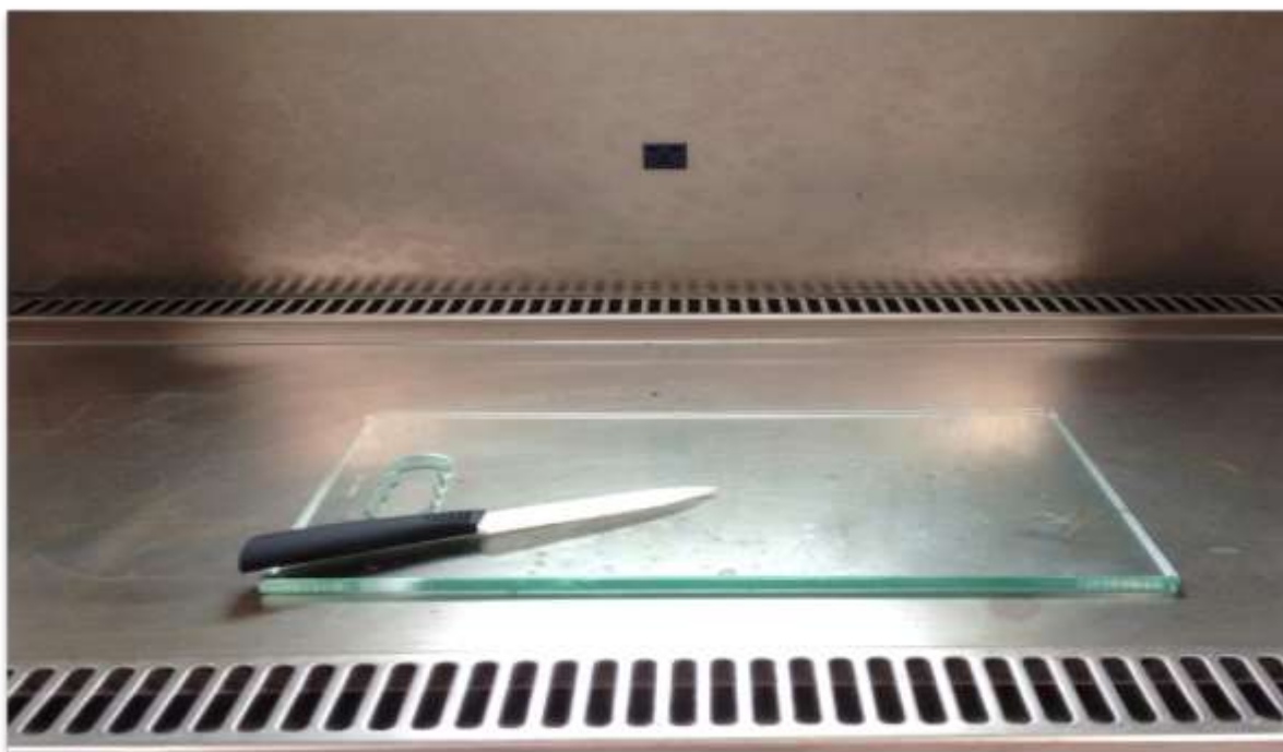
Figura II.1.1-2 - Faca de cerâmica, tábua de vidro e capela de fluxo laminar utilizados na reamostragem das amostras.
