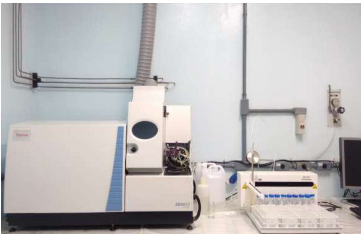
Figura II.2.2.1-1 - Espectrômetro de massas com plasma acoplado indutivamente utilizado para as determinações de As, Cd, Cr, Cu, Pb, Mn, Mo, Zn, Ni, Ba e V.
