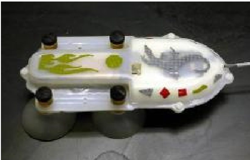
Figura 3-7: DTAG com sistema de fixação tipo suction cup que será utilizado em diferentes espécies de cetáceos na Bacia de Santos
