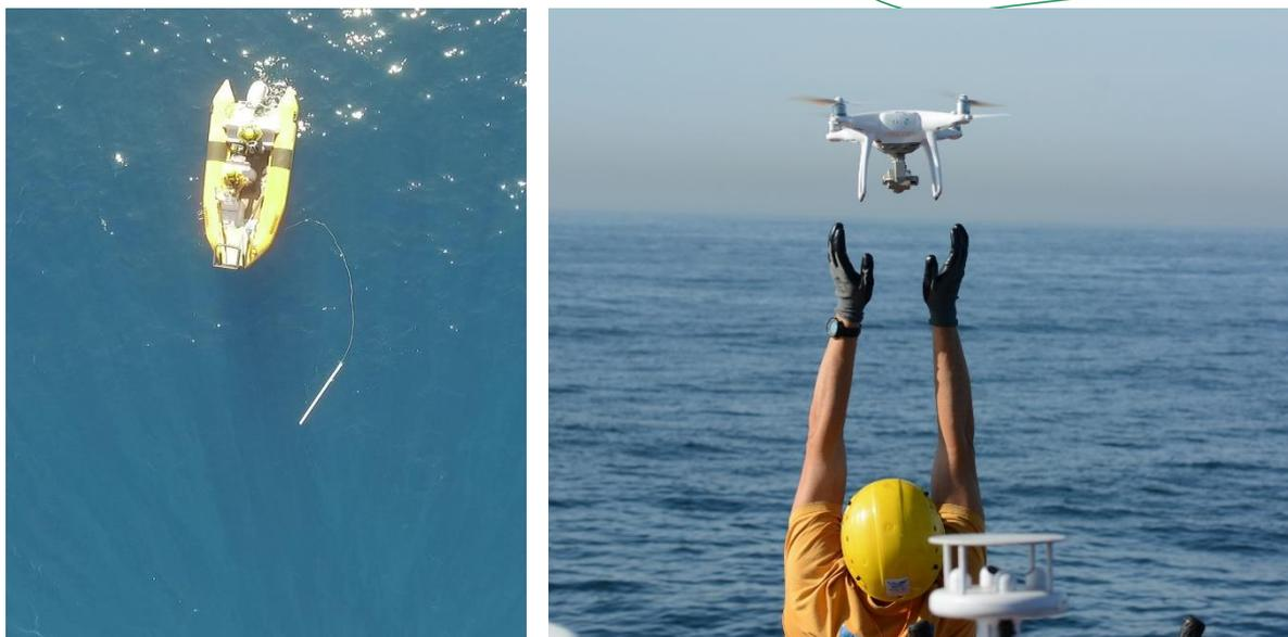
**Figura V.3.5-1:** Calibração da imagem do VANT utilizando uma escala feita de PVC de 2 metros, flutuando e enquadrada no centro da tela (esquerda) e recuperação do VANT após procedimento de fotogrametria (direita).
