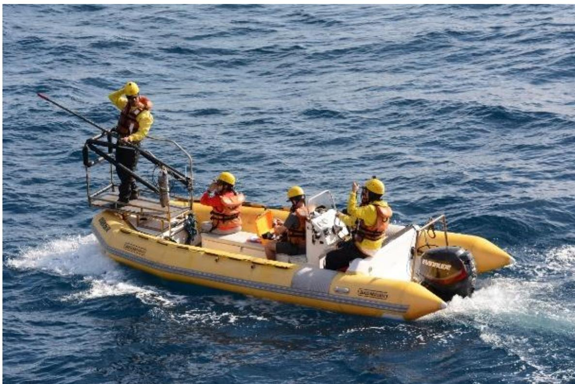
**Figura III-5:** Vista geral do bote inflável principal (6,3 m) usado nas Campanhas de Telemetria do PMC-BS.
