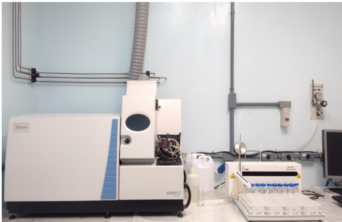
Figura VII.1.3-1 – Espectrômetro de massas com plasma acoplado indutivamente utilizado para as determinações de As, Cd, Cr, Cu, Pb, Mn, Mo, Zn, Ni, Ba e V.
