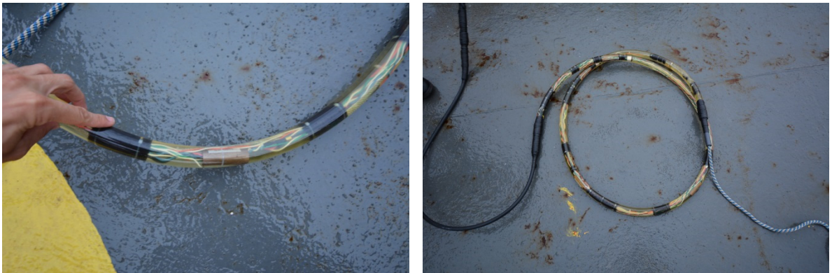
Figura II.3-1: Arranjo de hidrofones em tubo preenchido a óleo utilizados durante as campanhas de MAP no primeiro ano do PMC-BS.
