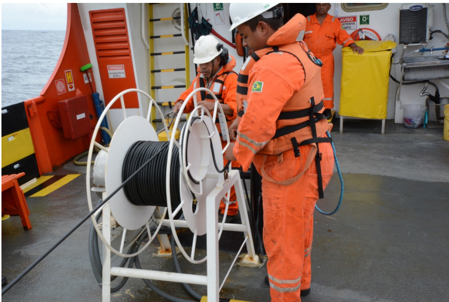
Figura II.3-2: Guincho hidráulico e cabo de reboque com arranjo de hidrofones usados no MAP durante lançamento ao mar no PMC-BS.
