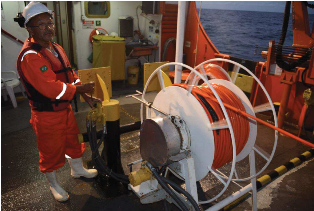
Figura III.3-1: Recolhimento do arranjo de hidrofones a partir do guincho hidráulico. O cabo laranja enrolado no guincho é o cabo de reboque.
