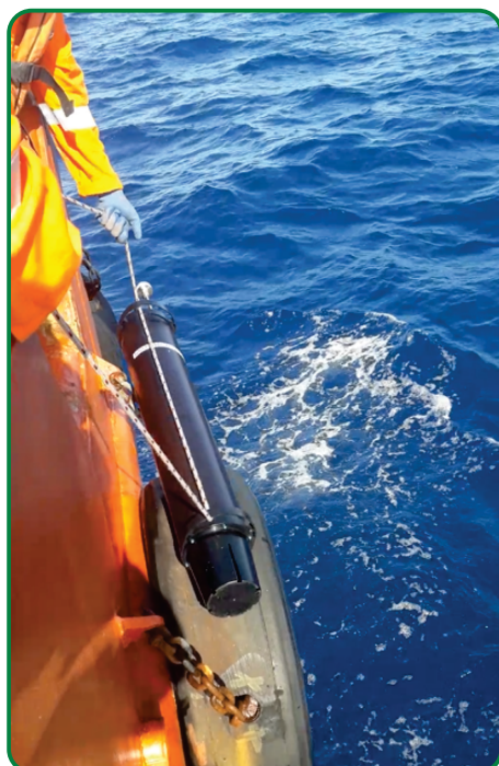
Perfilador - Equipamento de registro sonoro que se desloca com as correntes
