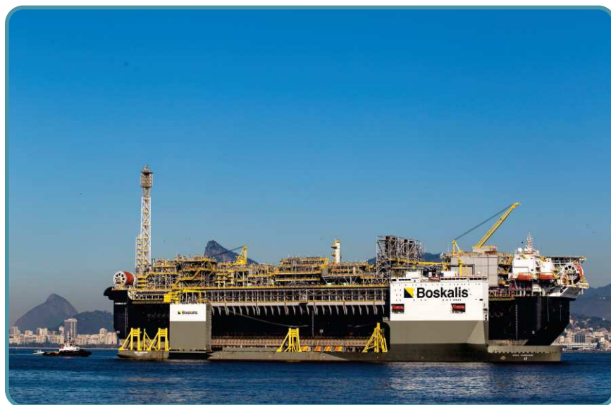
FPSO P-67 vai operar no campo de Lula Norte. Navio-plataforma pesa 353 mil toneladas e tem 288 metros de comprimento
