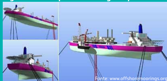
Imagem 08: Exemplo de ancoragem Spread Mooring
