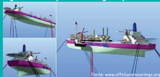
Imagem 08: Exemplo de ancoragem Spread Mooring
