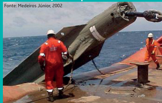
Imagem 11: Estaca torpedo utilizada para fixar a unidade de produção nas coordenadas de lançamento pré-definidas.
