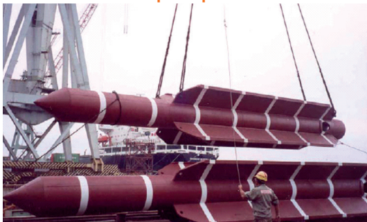
Imagem 23: Na ancoragem são utilizados estacas do tipo torpedo.
