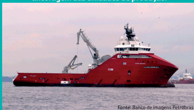
Imagem 10: Exemplo de navio AHTS ( Anchor Handling Tug Supply ) que poderá ser utilizado na instalação da ancoragem das unidades de produção.
