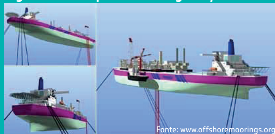
Imagem 08: Exemplo de ancoragem Spread Mooring
