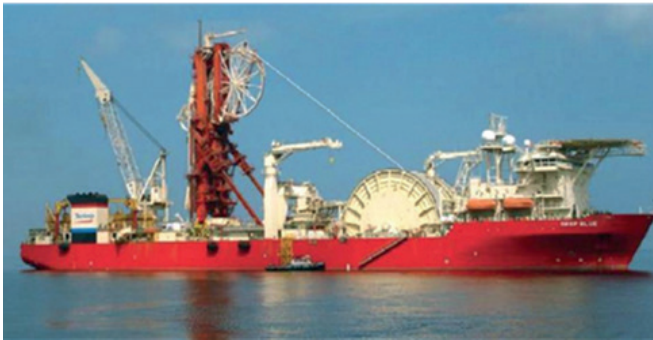
Imagem 05: Exemplo de embarcação utilizada para instalação de linhas (dutos).
