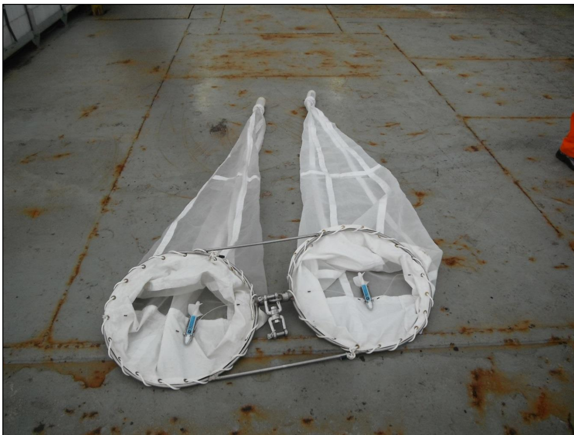
Figura IV-7 – Rede bongô com malhas de 300 e 500 \mu\text{m} para coleta de amostras de ictioplâncton, utilizada durante a 2ª campanha de monitoramento ambiental do DP-BUZ-1, fase de operação.
