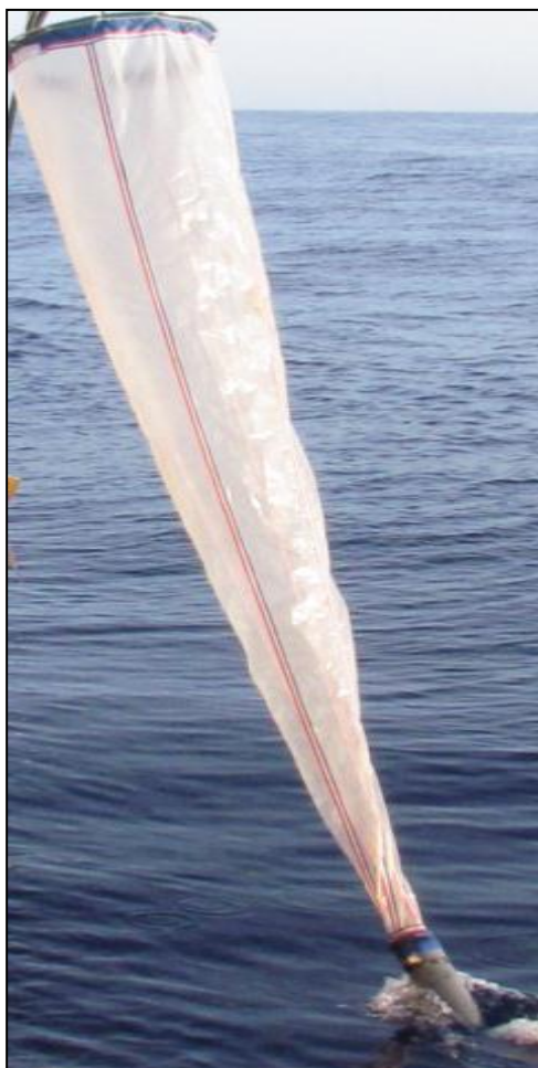
Figura IV-6 – Rede cilindro-cônica com malha de 200 \mu m para coleta de amostras de zooplâncton utilizada durante a 2ª campanha de monitoramento ambiental do DP-BUZ-1, fase de operação.
