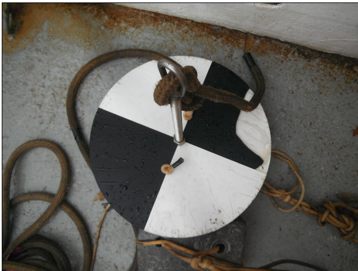
Figura IV-5 – Disco de Secchi utilizado para medir a transparência da coluna da água durante a 2ª Campanha de Monitoramento Ambiental do DP-BUZ-1.
