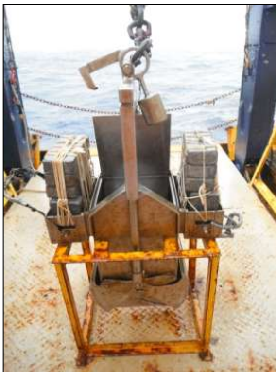
Figura IV-9 – Mini Box Corer (30 x 30 x 50 cm) utilizado para a coleta de amostras de sedimento e bentos, durante a 8ª campanha do Projeto de Monitoramento Ambiental do Desenvolvimento da Produção de Petróleo dos Campos de Baúna e Piracaba, Bloco BM-S-40, fase de operação.
