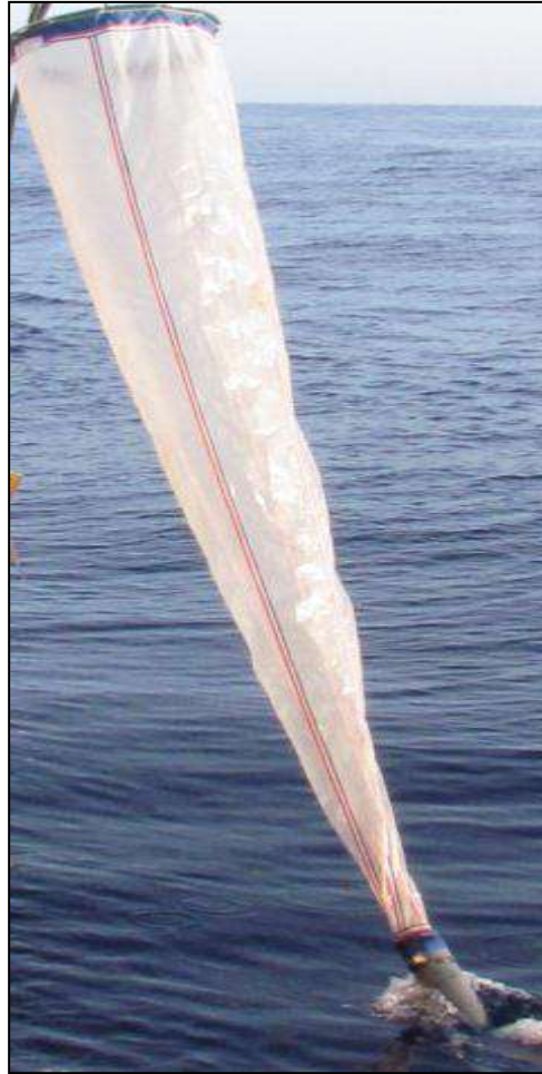
Figura IV-7 – Rede cilindro-cônica com malha de 200 \mu\text{m} para coleta de amostras de zooplâncton utilizada durante a 8ª campanha do Projeto de Monitoramento Ambiental do Desenvolvimento da Produção de Petróleo dos Campos de Baúna e Piracaba, Bloco BM-S-40, fase de operação.
