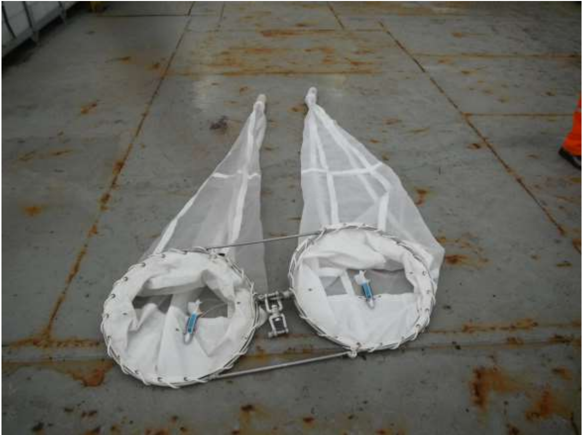
Figura IV-8 – Rede bongô com malhas de 300 e 500 \mu\text{m} para coleta de amostras de ictioplâncton, utilizada durante a 8ª campanha do Projeto de Monitoramento Ambiental do Desenvolvimento da Produção de Petróleo dos Campos de Baúna e Piracaba, Bloco BM-S-40, fase de operação.
