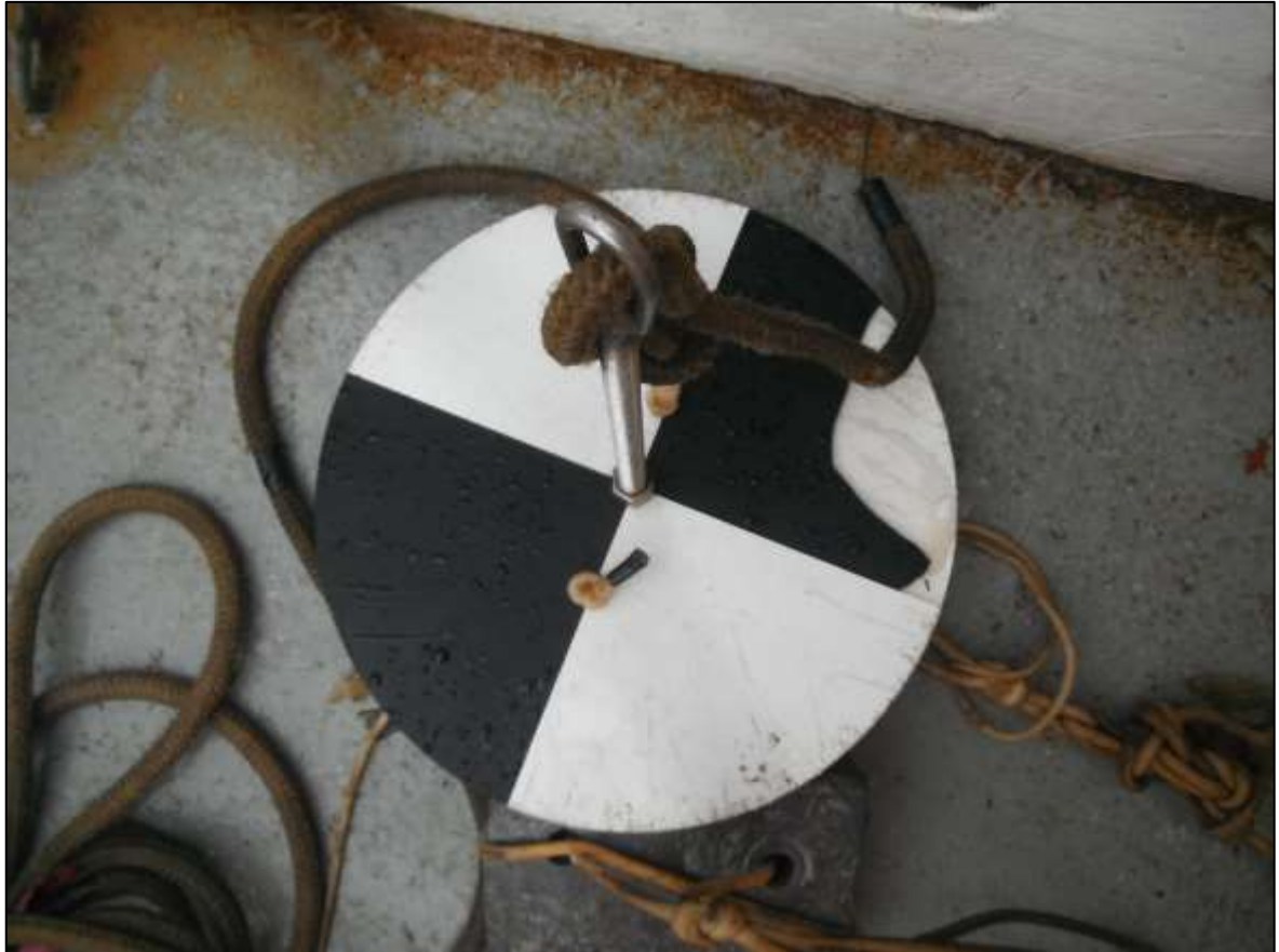
Figura IV-6 – Disco de Secchi utilizado para medir a transparência da coluna da água durante a 8ª campanha do Projeto de Monitoramento Ambiental do Desenvolvimento da Produção de Petróleo dos Campos de Baúna e Piracaba, Bloco BM-S-40, Bacia de Santos, fase de operação.
