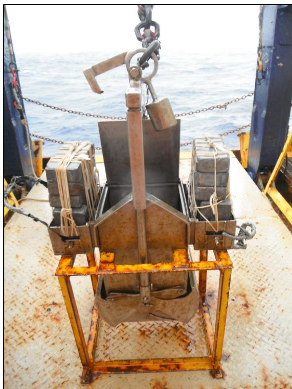
Figura IV-3 – Mini Box-corer 30 x 30 x 50 cm utilizado na coleta das amostras de sedimento da presente campanha.
