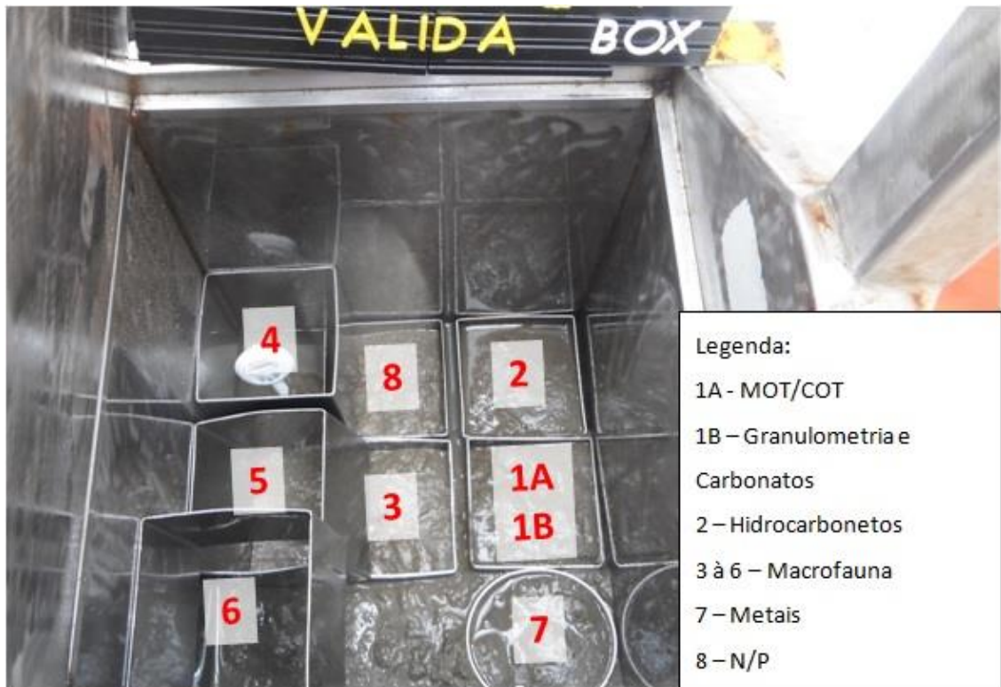
Figura IV-4 - Esquema de distribuição dos corers no Mini-box corer (30 x 30 x 50 cm) para subamostragem dos parâmetros de análise do sedimento e macrofauna bentônica, durante a 3ª campanha (fase de pós-perfuração, 2º retorno) do poço EIAR-ADR5.
