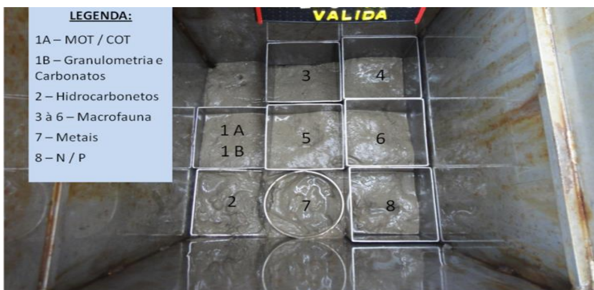
Figura IV.1-4 - Esquema de distribuição dos corers no mini Box-corer (30 x 30 x 50 cm) para subamostragem dos parâmetros solicitados durante a atual campanha de pós-perfuração do poço Franco-SP2.
