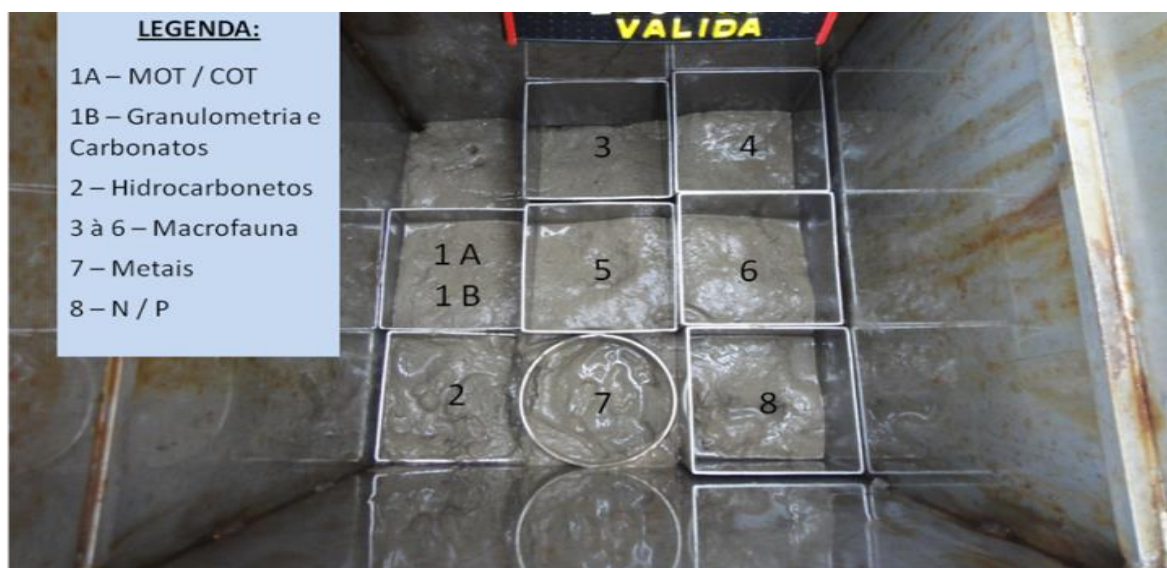
Figura IV.1-4 - Esquema de distribuição dos corers no Box-corer (30 x 30 x 50 cm) para subamostragem dos parâmetros solicitados durante a 2ª campanha de pós-perfuração do poço Uruguá GH1.
