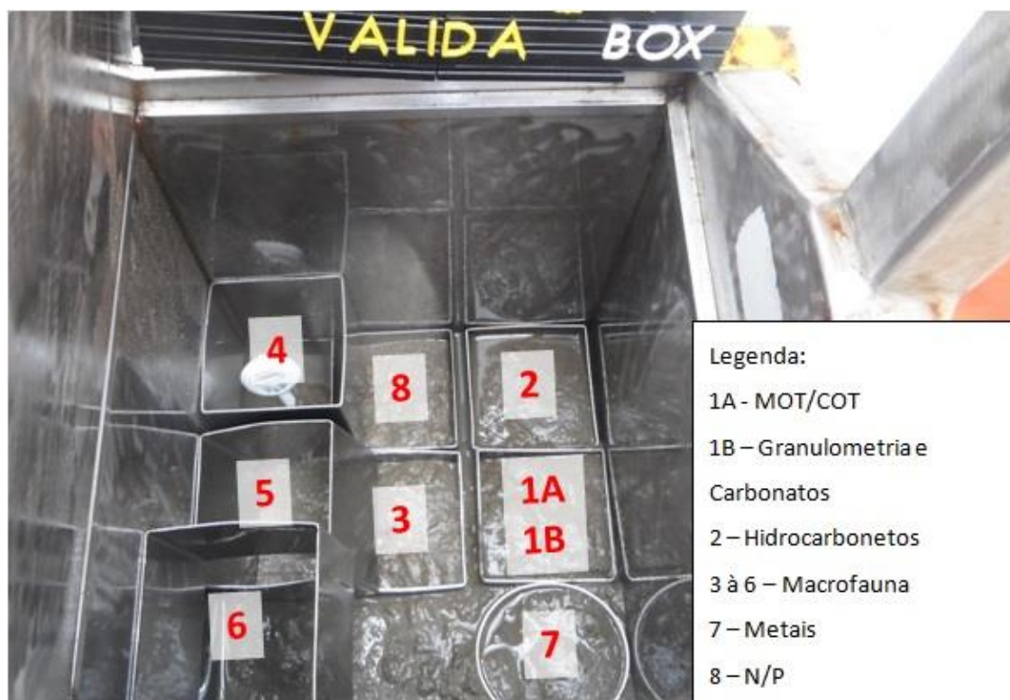
Figura IV-4 - Esquema de distribuição dos corers no Mini-box corer (30 x 30 x 50 cm) para subamostragem dos parâmetros de análise do sedimento e macrofauna bentônica, durante a 3ª campanha (fase de pós-perfuração, 2º retorno) do poço ITP-ADR1.
