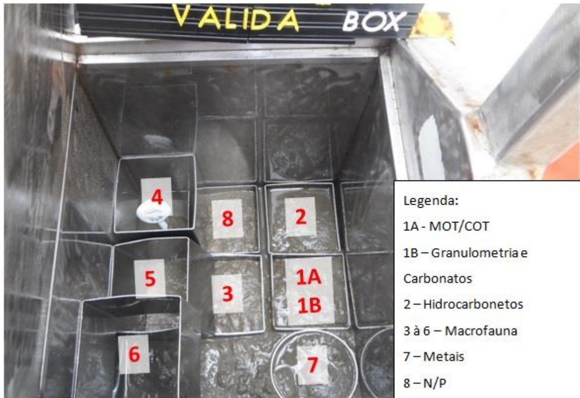
Figura IV-4 - Esquema de distribuição dos corers no Mini-box corer (30 x 30 x 50 cm) para subamostragem dos parâmetros de análise do sedimento e macrofauna bentônica, durante a 3ª campanha (fase de pós-perfuração) do poço LBR-NW2.
