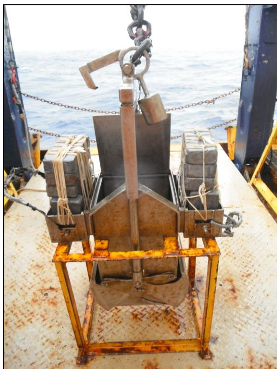
Figura IV-3 – Mini Box-corer 30 x 30 x 50cm utilizado na coleta das amostras de sedimento da atual campanha.
