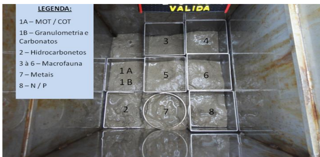
Figura IV.1-4 - Esquema de distribuição dos corers no Mini-box corer (30 x 30 x 50 cm) para subamostragem dos parâmetros solicitados durante a atual campanha de pós-perfuração do poço LL-IA1.
