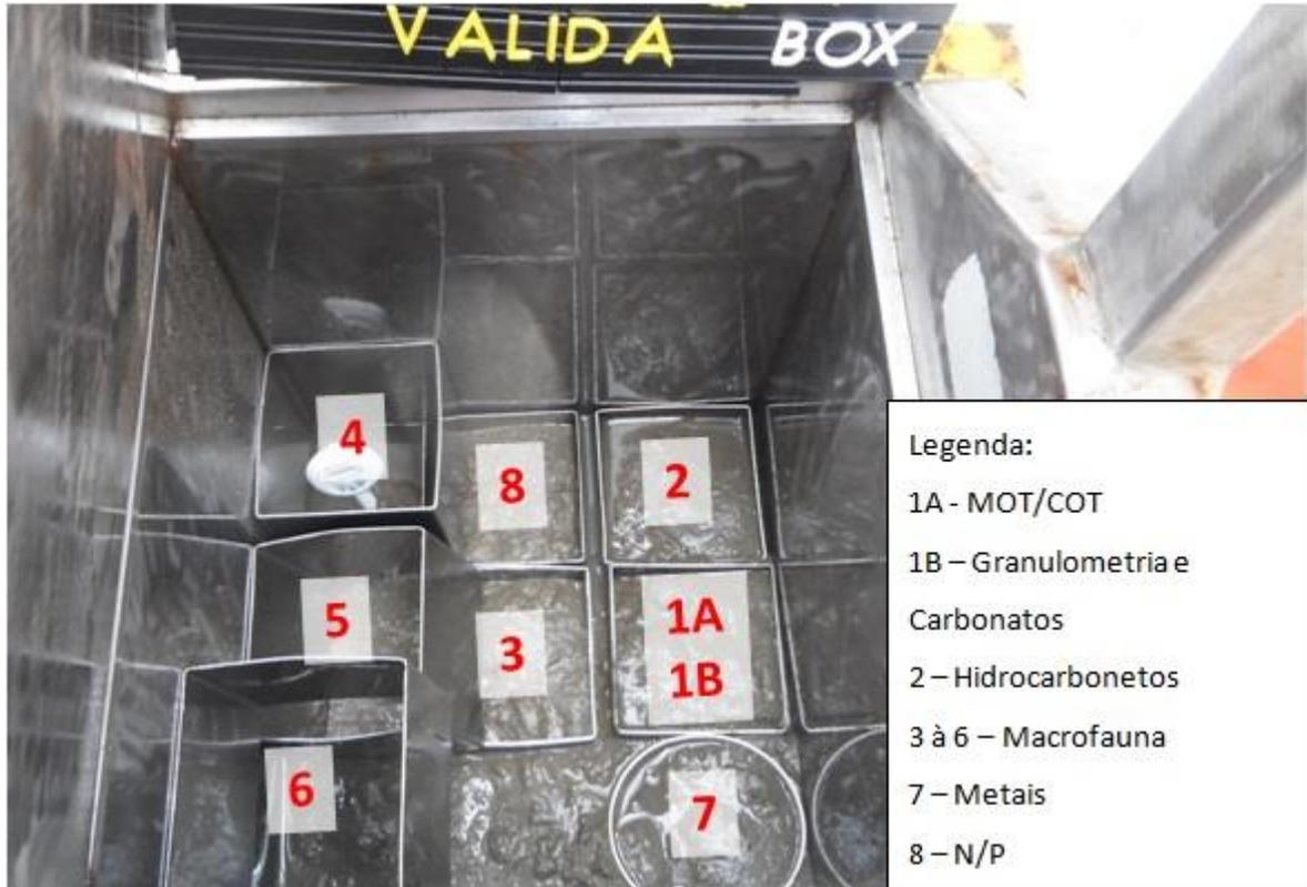
**Figura IV-4** - Esquema de distribuição dos corers no Mini-box corer (30 x 30 x 50 cm) para subamostragem dos parâmetros de análise do sedimento e macrofauna bentônica, durante a 3ª campanha (fase de pós-perfuração, 2º retorno) do poço LL-IRA-IN1.
