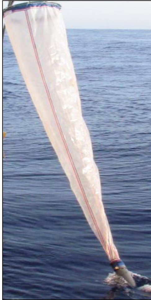
Figura IV-7 – Rede cilindro-cônica com malha de 200 \mu\text{m} para coleta de amostras de zooplâncton utilizada durante a 11ª campanha do Projeto de Monitoramento Ambiental da fase de operação da Atividade de Produção e Escoamento de Gás Natural e Condensado no Campo de Merluza, Bacia de Santos.
