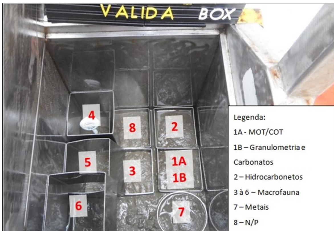
Figura IV-10 – Esquema de distribuição dos corers no Mini Box Corer para sub-amostragem dos parâmetros analisados.
