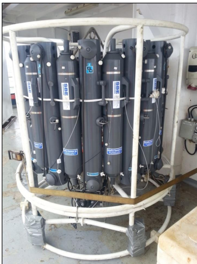
Figura IV-5 – Rosette com garrafas de coleta de amostras de água dos modelos Niskin e Go-flo utilizadas na atual campanha de monitoramento.
