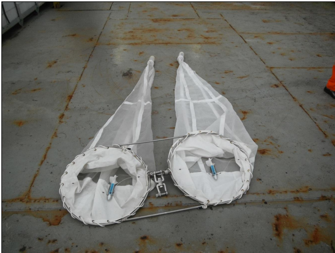
Figura IV-8 – Rede bongô com malhas de 300 e 500 \mu\text{m} para coleta de amostras de ictioplâncton, utilizada durante a 11 a campanha do Projeto de Monitoramento Ambiental da fase de operação da Atividade de Produção e Escoamento de Gás Natural e Condensado no Campo de Merluza, Bacia de Santos.
