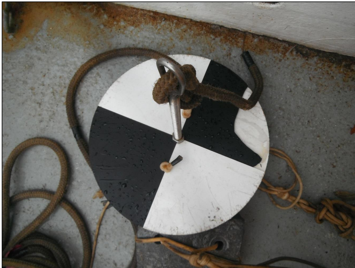
Figura IV-6 – Disco de Secchi utilizado para medir a transparência da coluna da água durante a 11ª campanha do Projeto de Monitoramento Ambiental da fase de operação da Atividade de Produção e Escoamento de Gás Natural e Condensado no Campo de Merluza, Bacia de Santos.
