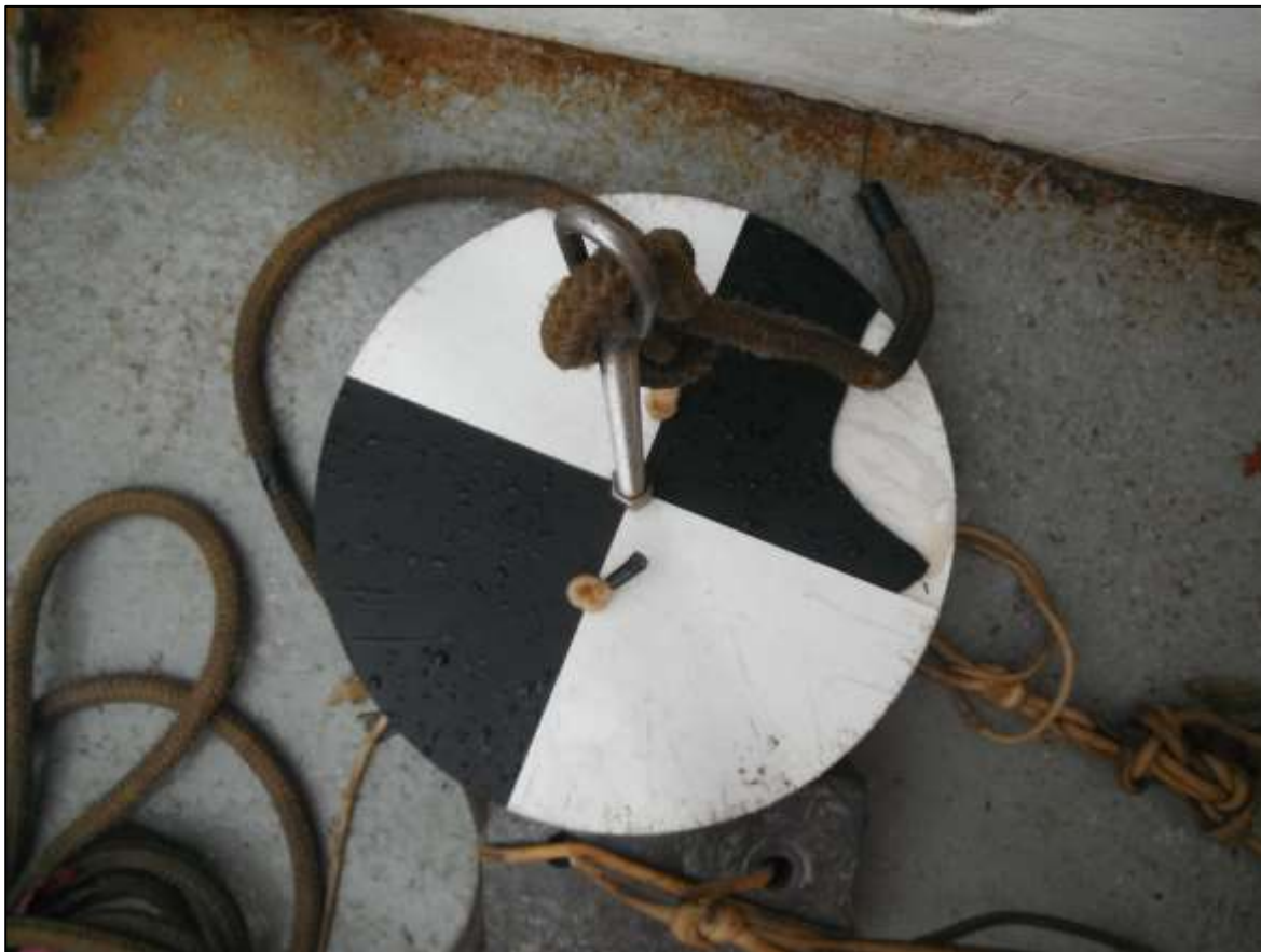
Figura IV-6 – Disco de Secchi utilizado para medir a transparência da coluna da água durante a 10ª campanha do Projeto de Monitoramento Ambiental da fase de operação da Atividade de Produção e Escoamento de Gás Natural e Condensado no Campo Mexilhão, Bacia de Santos.
