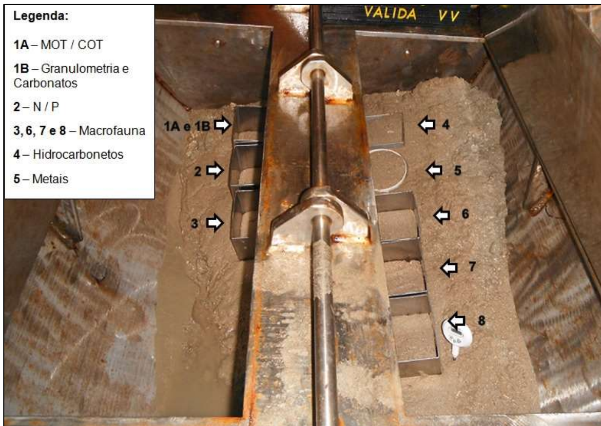
Figura IV-10 – Esquema de distribuição dos corers no van Veen para sub-amostragem dos parâmetros analisados.
