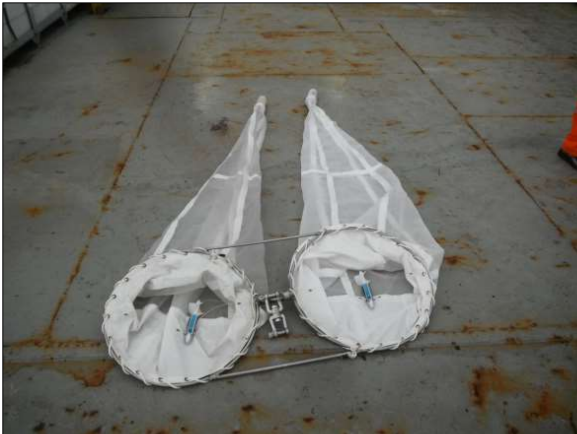
Figura IV-8 – Rede bongô com malhas de 300 e 500 \mu\text{m} para coleta de amostras de ictioplâncton, utilizada durante a 10ª campanha do Projeto de Monitoramento Ambiental da fase de operação da Atividade de Produção e Escoamento de Gás Natural e Condensado no Campo Mexilhão.
