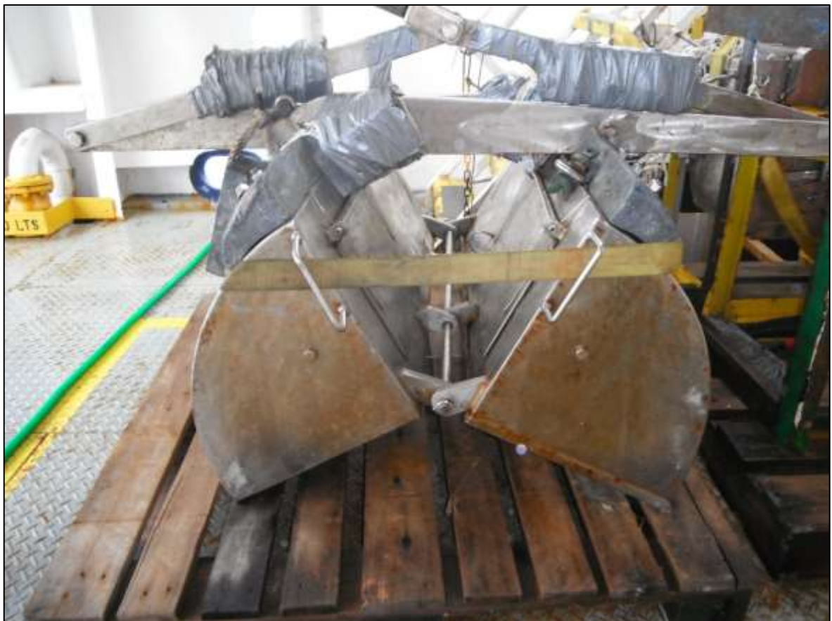
Figura IV-9 – Van Veen de 231L, utilizado para a coleta de amostras de sedimento e bentos, durante a 10ª campanha do Projeto de Monitoramento Ambiental da fase de operação da Atividade de Produção e Escoamento de Gás Natural e Condensado no Campo Mexilhão.
