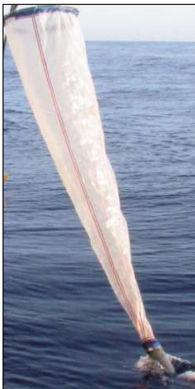
Figura IV-7 – Rede cilindro-cônica com malha de 200 \mu\text{m} para coleta de amostras de zooplâncton utilizada durante a 10ª campanha do Projeto de Monitoramento Ambiental da fase de operação da Atividade de Produção e Escoamento de Gás Natural e Condensado no Campo Mexilhão.
