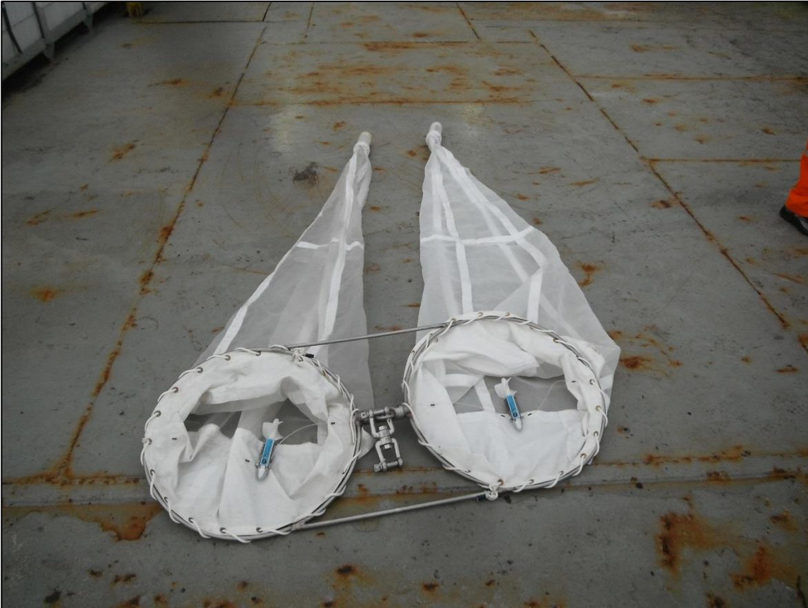
Figura IV-7 – Rede bongô com malhas de 300 e 500 \mu\text{m} para coleta de amostras de ictioplâncton, utilizada durante a 7ª campanha de monitoramento ambiental do Piloto de Lula NE, fase de operação.
