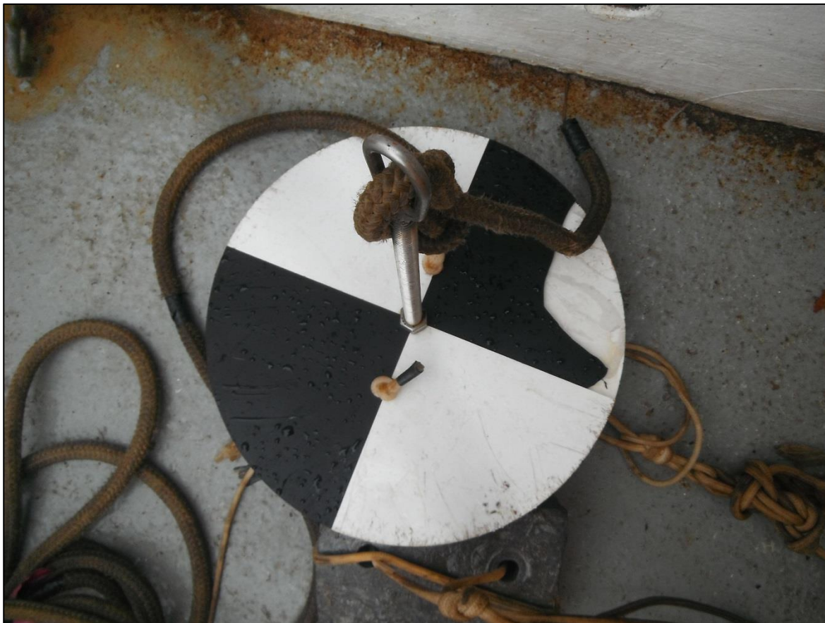
Figura IV-5 – Disco de Secchi utilizado para medir a transparência da coluna da água durante a 7ª campanha de monitoramento ambiental do Piloto de Lula NE.
