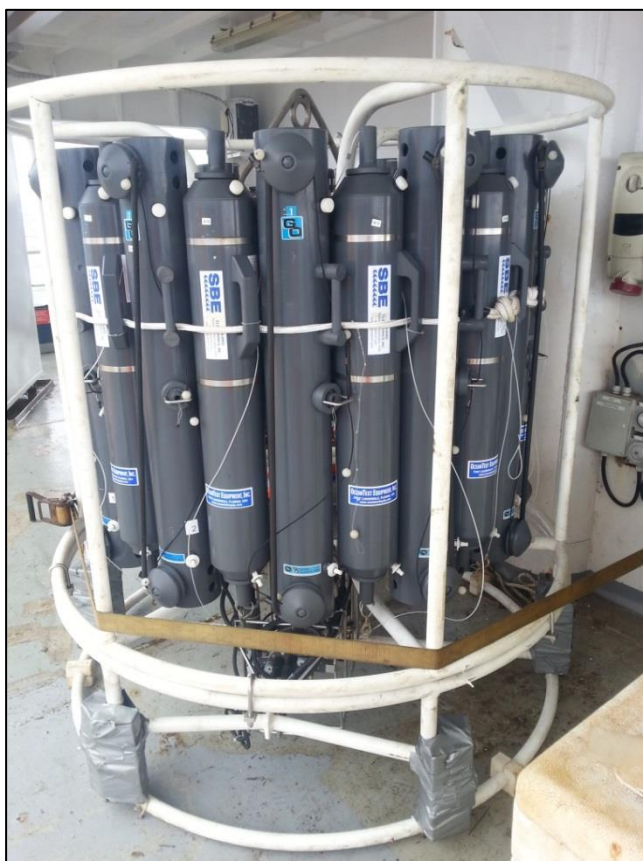
Figura IV-4 – Rosette com garrafas de coleta de amostras de água dos modelos Niskin e Go-flo utilizadas na atual campanha de monitoramento.
