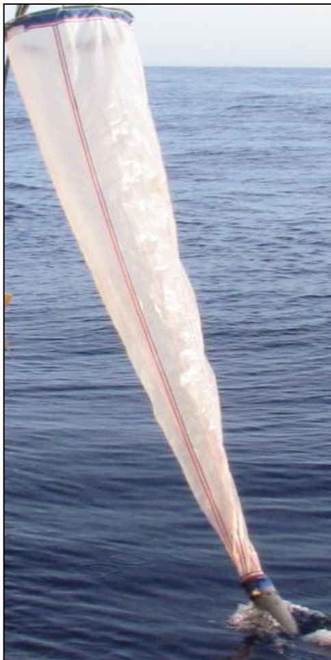
Figura IV-6 – Rede cilindro-cônica com malha de 200 \mu m para coleta de amostras de zooplâncton utilizada durante a 7ª campanha de monitoramento ambiental do Piloto de Lula NE, fase de operação.
