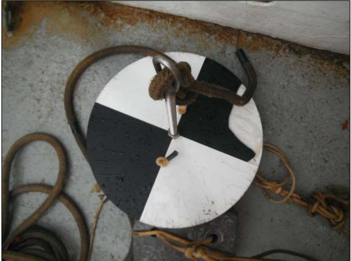
Figura IV-5 – Disco de Secchi utilizado para medir a transparência da coluna da água durante a 7ª Campanha de Monitoramento Ambiental do Piloto de Sapinhoá.
