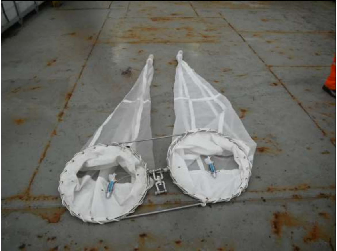
Figura IV-7 – Rede bongô com malhas de 300 e 500 \mu\text{m} para coleta de amostras de ictioplâncton, utilizada durante a 7ª campanha de monitoramento ambiental do Piloto de Sapinhoá, fase de operação.
