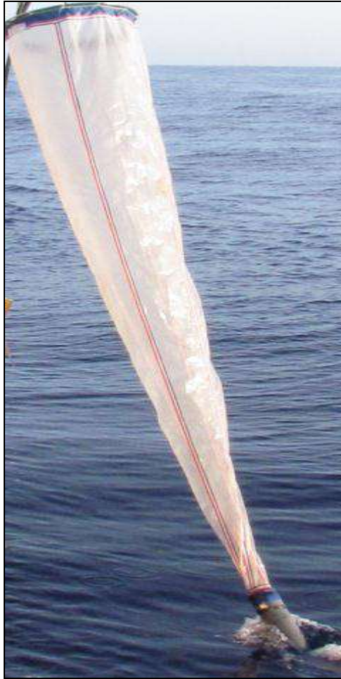
Figura IV-6 – Rede cilindro-cônica com malha de 200 \mu\text{m} para coleta de amostras de zooplâncton utilizada durante a 7ª campanha de monitoramento ambiental do Piloto de Sapinhoá, fase de operação.
