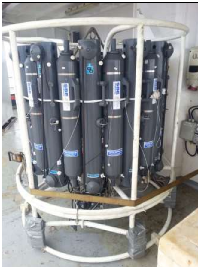
Figura IV-3 – Rosette com garrafas de coleta de amostras de água dos modelos Niskin e Go-flo utilizadas no atual ciclo de monitoramento.
