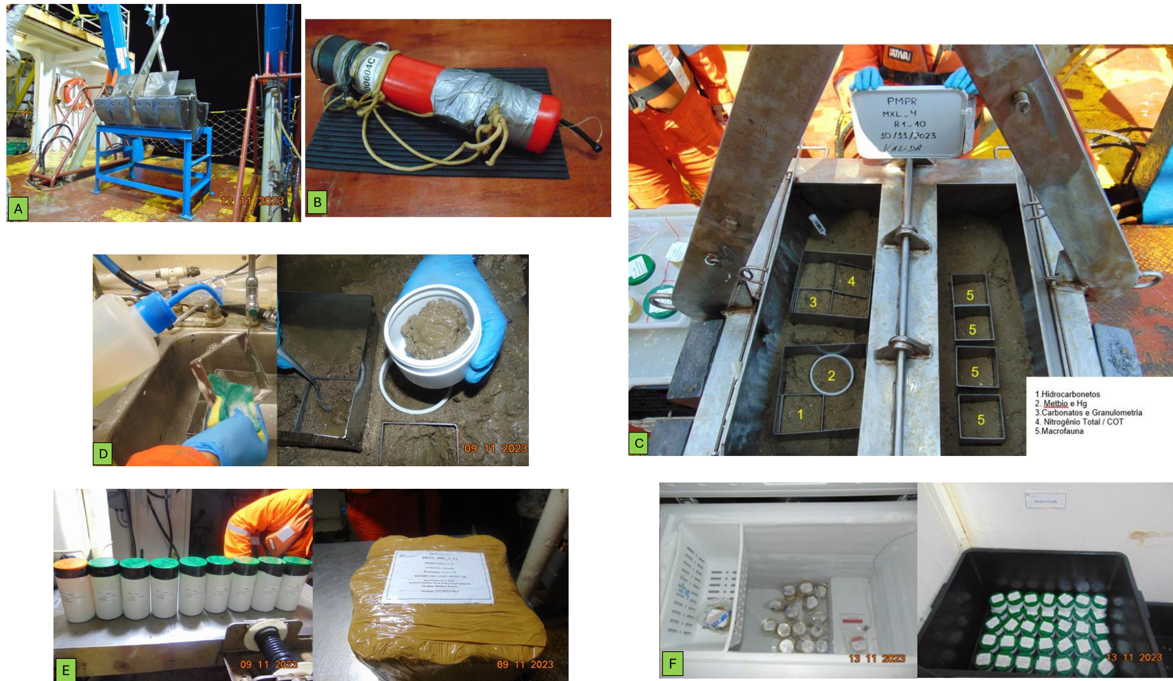
Figura IV-5 – Equipamento e processos envolvidos na coleta e armazenamento das amostras de sedimento na campanha PMPR_MXL_C17.
