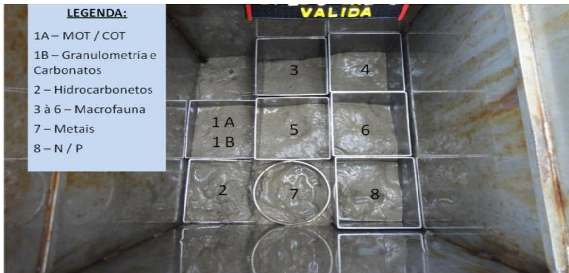
**Figura IV.1-4** – Esquema de distribuição dos corers no Box-corer (30 x 30 x 50 cm) para sub-amostragem dos parâmetros solicitados durante a atual campanha de pós-perfuração do poço Piracaba-SP3.
