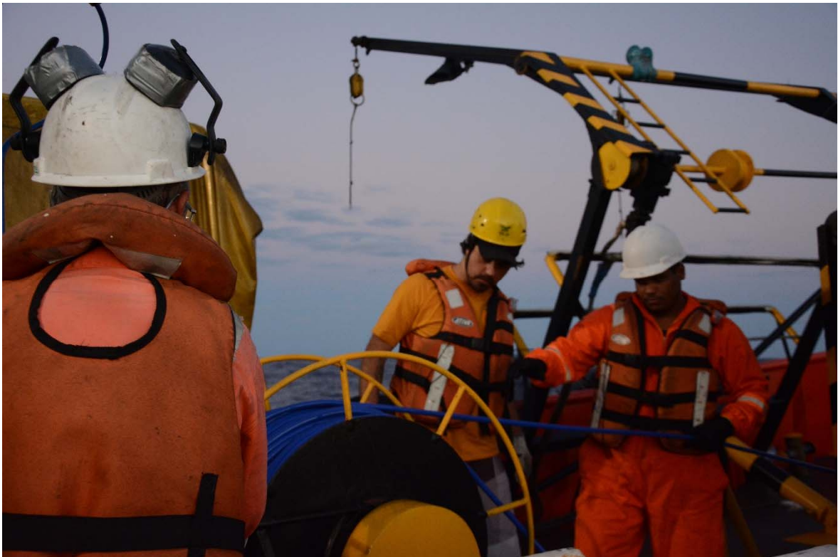
Figura III.3-1: Lançamento do arranjo de hidrofones e cabo de reboque.
